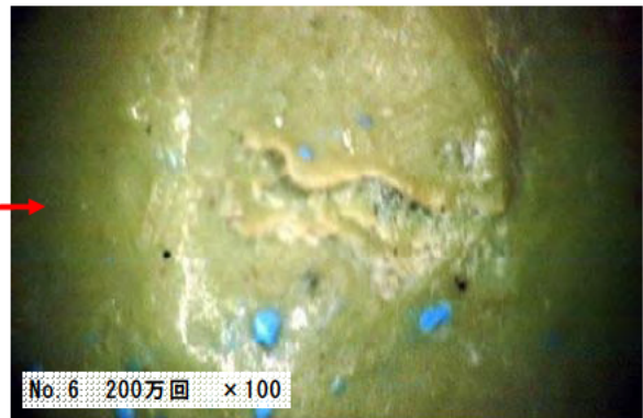
写真-資 6. 22 No. 6 位置損傷状況 (B018 試験体)
