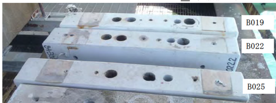
写真-4.1.3 コンクリート塗装試験体
