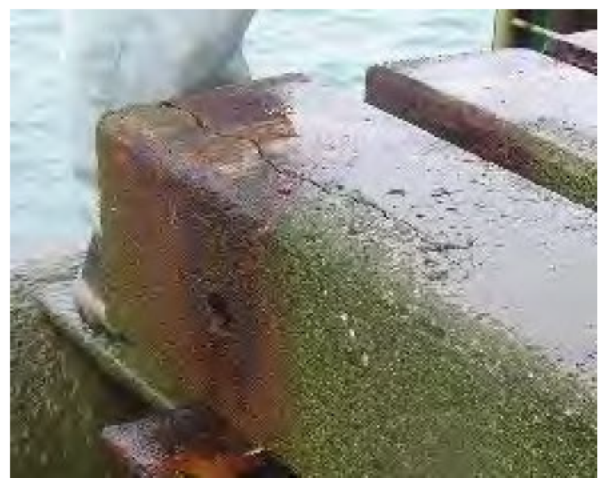
写真-4.1.2 第3デッキ試験体損傷状況（暴露26年）
