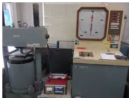
写真-3.2.1 圧縮強度試験状況
