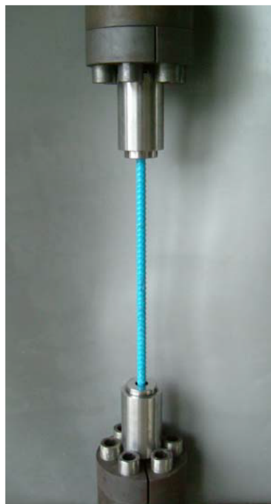
写真-資 6.1 疲労試験機
