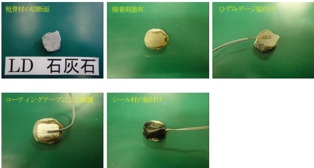
**写真3.4.1 粗骨材の加工状況**
