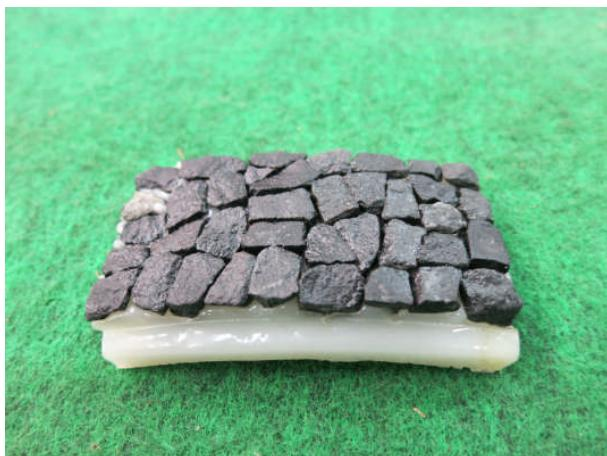
写真3.5.1 PSV試験用供試体
