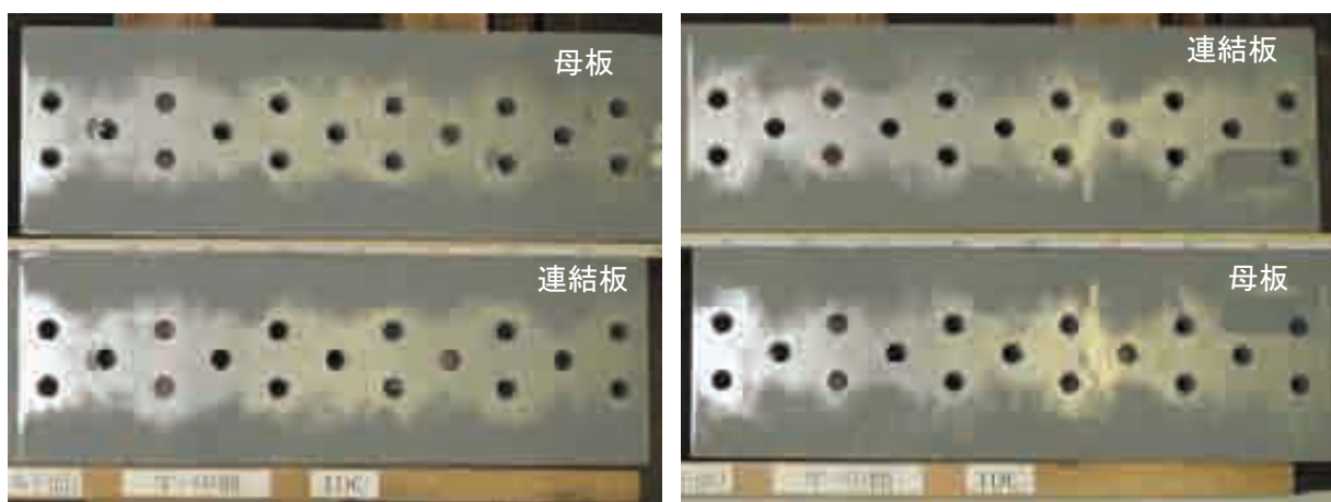
写真- 1.5.15 試験体 No.10-C すべり面の状況(左:ボルト側, 右:ナット側)
