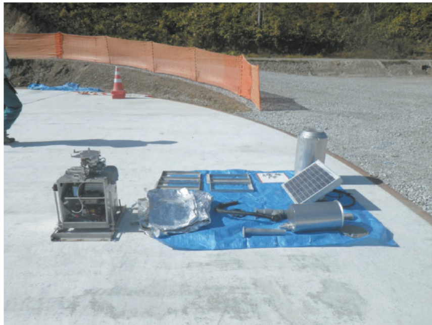
図 25 解体した自動降灰・降雨量計
