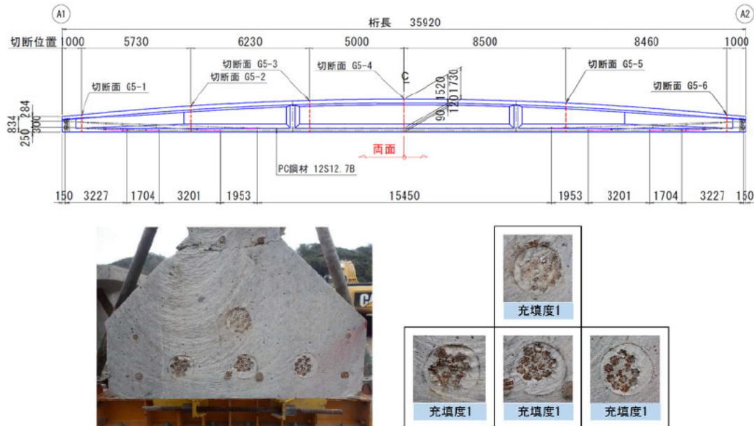
図 2.2.1 撤去桁の切断によるグラウト充填状況の確認 (アヒン橋の例)
