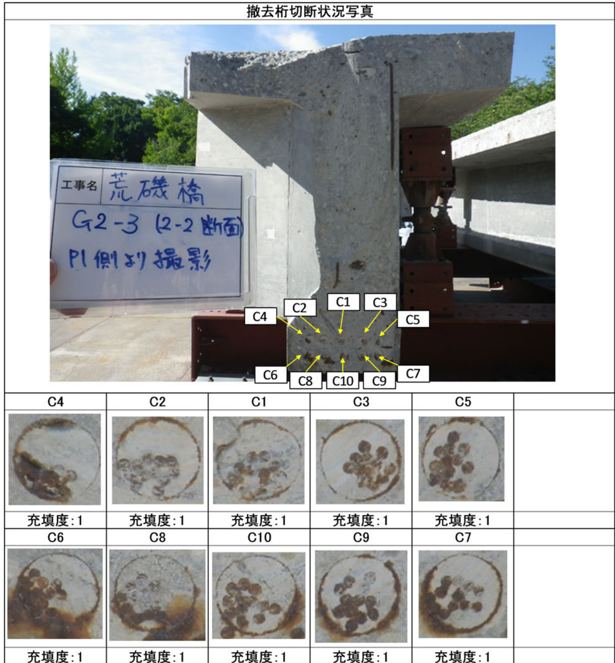
付写真 5.1 既設橋 G2 桁の支間中央 2-2 断面のグラウト充填状況
