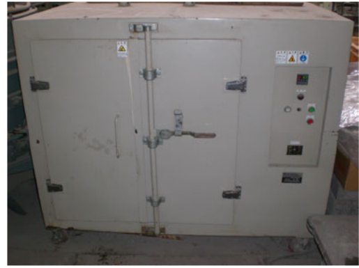
b) 恒温槽を使用した養生
