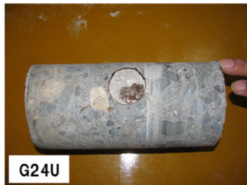
写真 4.2.1 コア削孔調査結果
