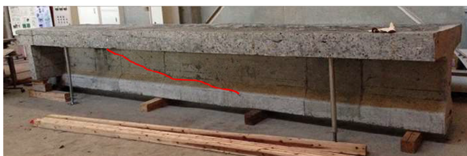
付写真 4.12 水張り試験体の外観
