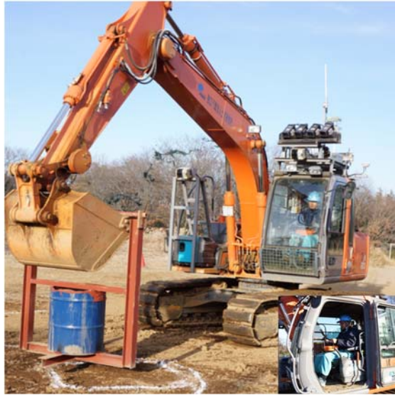
Fig. B-17 搭乗での遠隔操作状況
