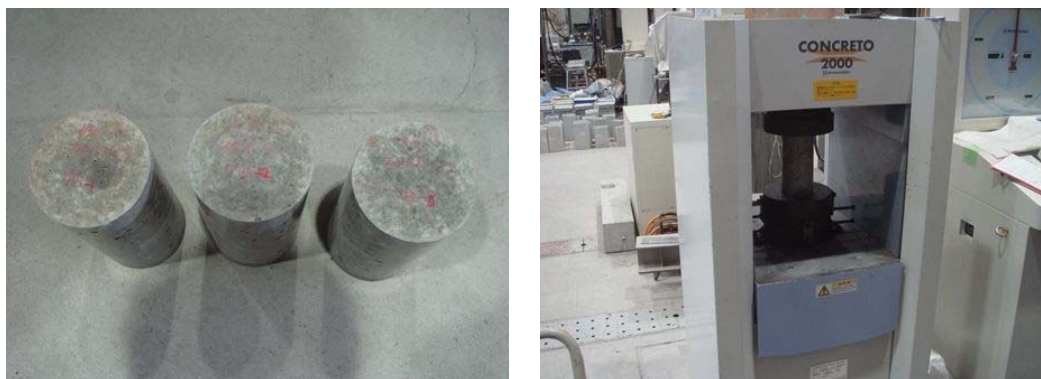
写真 4.2.4 コンクリート圧縮強度試験状況
