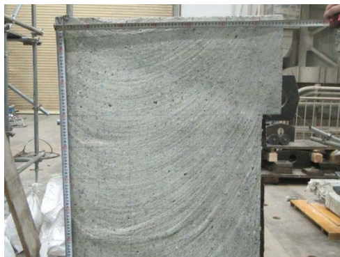
(a) 接合部中央付近上側の切断面
