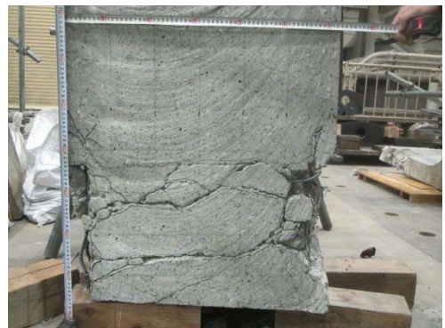
(b) 接合部中央付近下側の切断面
