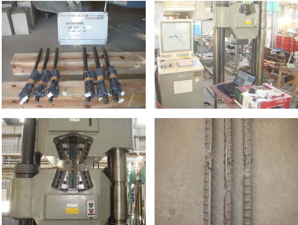
写真 4.2.3 鉄筋引張強度試験状況
