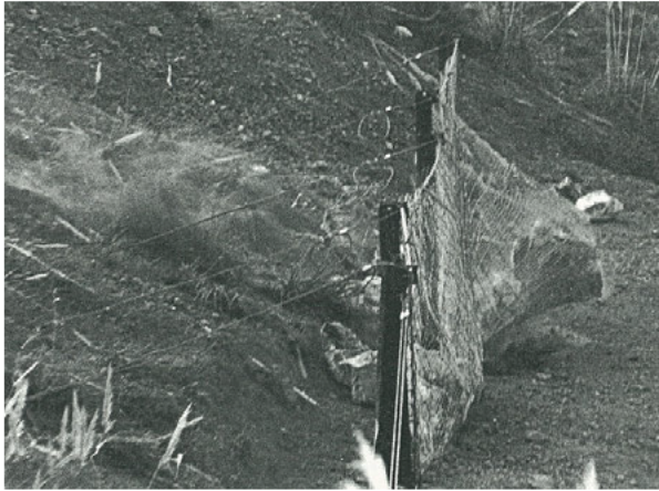
写真 3.1.1 CALTRAN で行われた斜面落石試験 1)
