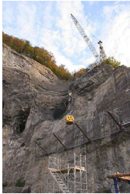
写真 3.1.3 鉛直落下による試験(スイス)
