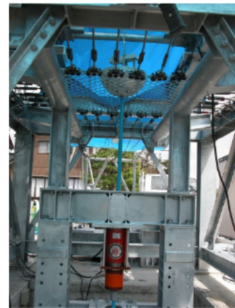
写真3.3.4 面外静的引張り試験
