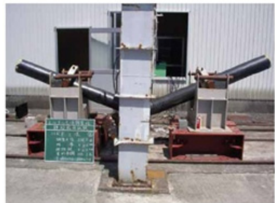
写真 3.3.2 衝撃曲げ試験状況
