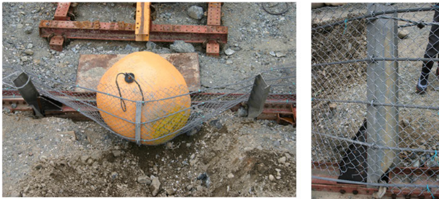
写真 2.3.4 中間支柱のフランジがロープの変形を拘束
