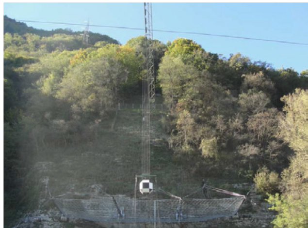
写真 3.1.5 鉛直落下による試験 (イタリア)
