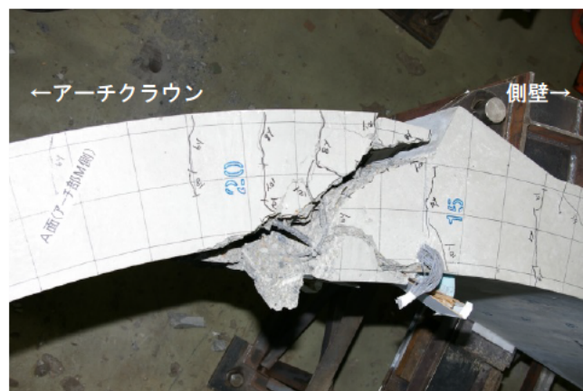
写真-3.1.3 アーチ肩部曲げせん断破壊状況
