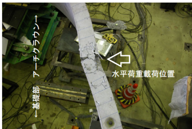
写真-3.3.6 水平荷重載荷点の破壊状況 曲げ破壊の状況，左右同様な破壊状態であった
