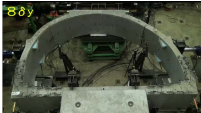
写真-3.2.2 載荷状況（水平変位作用中）
