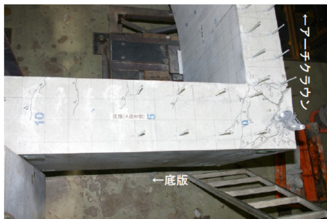
写真-3.1.6 隅角部損傷状況（上から撮影，曲げせん断破壊側の隅角部） 隅角部に対して，クロスするようなひび割れが発生している
