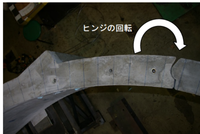
写真-3.2.11 終局後のヒンジ回転状況（内側へ回転）
