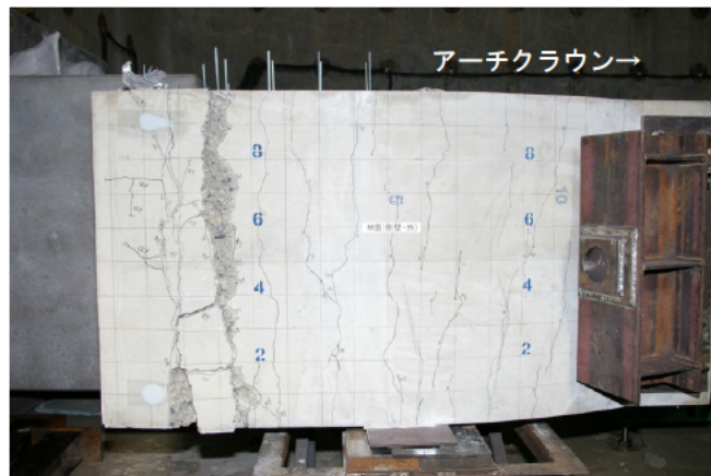
写真-3.1.8 側壁外側写真（曲げせん断破壊側の側壁） 曲げひび割れの分散，側壁基部のコンクリート剥落が確認された
