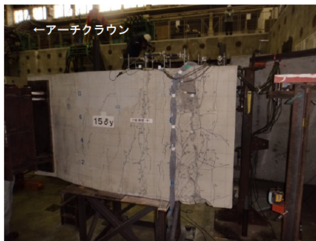
写真-3.1.9 側壁外側写真（写真-3.1.8 とは逆側） 同様にひび割れの分散，側壁基部のかぶりコンクリート剥落が確認された
