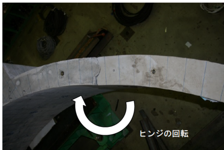
写真-3.2.9 終局後のヒンジ回転状況 (外側へ回転)
