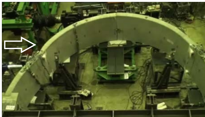
写真-3.3.3 荷重中の状況（水平変位作用中）
