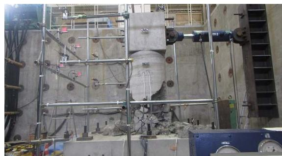
載荷試験後試験体(2) スパイラル式
