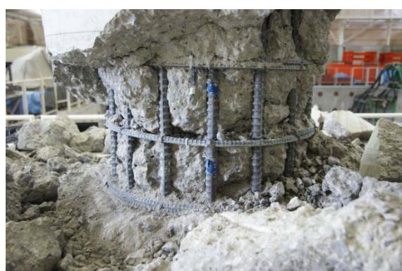
写真 3.2.15 かぶりコンクリート内部(載荷後)西面
