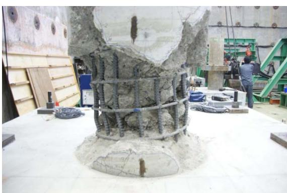
写真 3.2.29 かぶりコンクリート内部(載荷後)南面
