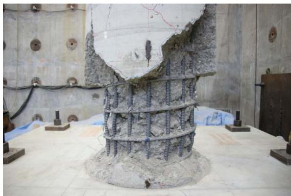
写真 3.2.27 かぶりコンクリート内部(載荷後)北面
