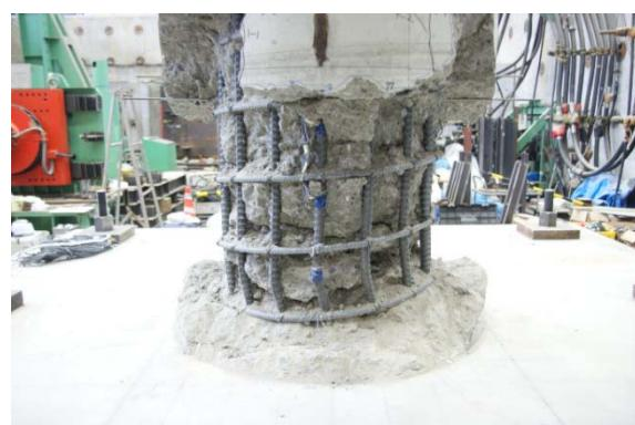
写真 3.2.30 かぶりコンクリート内部(載荷後)西面
