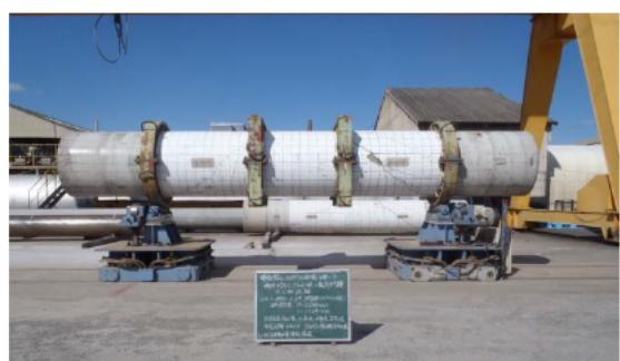
載荷試験後試験体(2) スパイラル式(E-A面)
