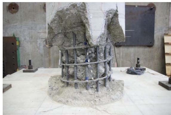
写真 3.2.28 かぶりコンクリート内部(載荷後)東面
