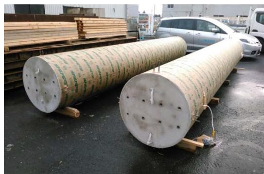
試験供試体養生状況
