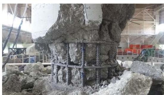
載荷試験後帯鉄筋確認(1) フック式
