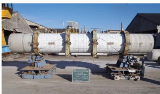
載荷試験後試験体(1) フック式(E-A面)
