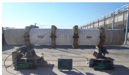
載荷試験後試験体(3) フック式(G-C面)
