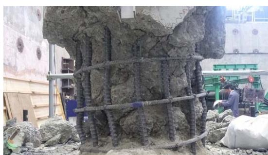
載荷試験後帯鉄筋確認(2) スパイラル式
