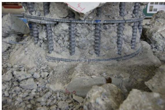
写真 3.2.12 かぶりコンクリート内部(載荷後)北面
