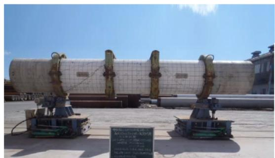
載荷試験後試験体(4) スパイラル式(G-C面)
