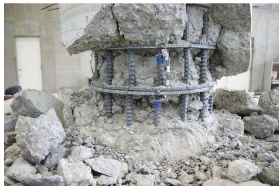
写真 3.2.13 かぶりコンクリート内部(載荷後)東面
