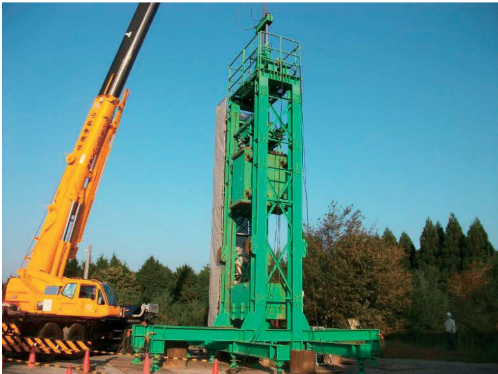
写参 8.3.4 急速載荷試験状況
