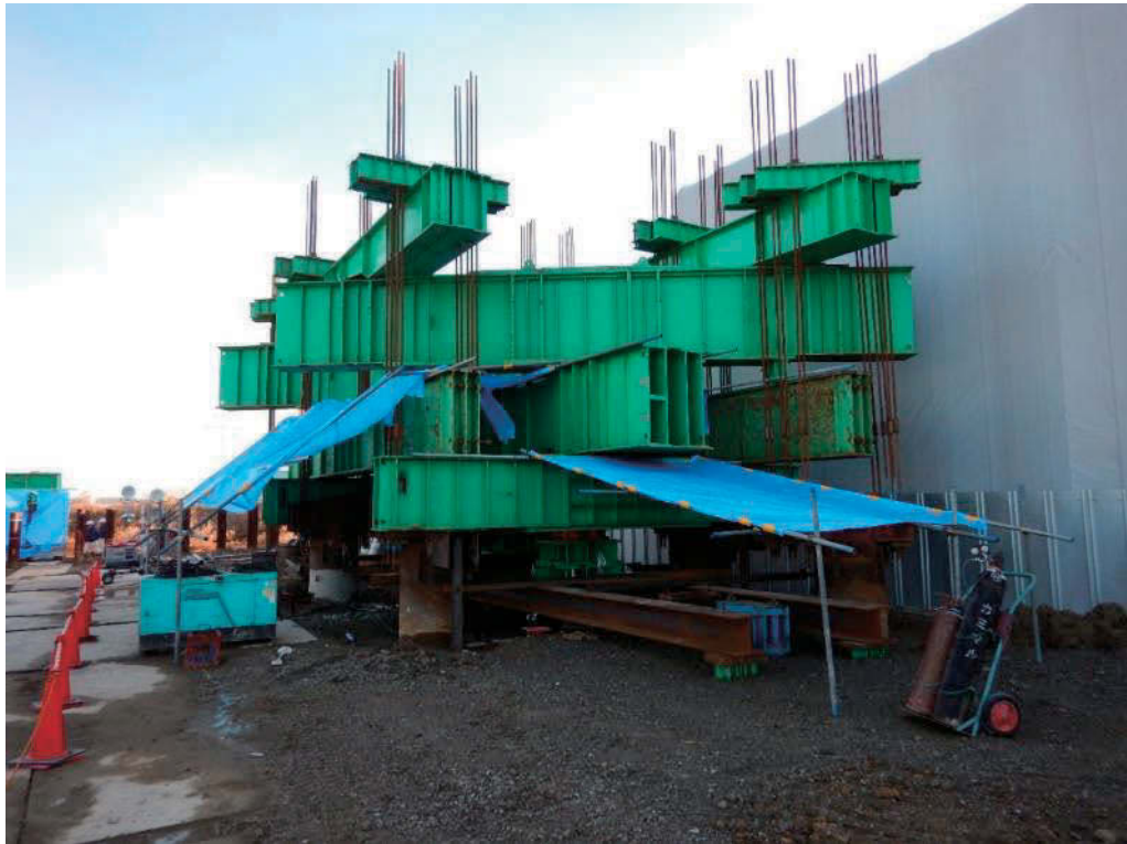
写参 8.3.1 静的載荷試験状況
