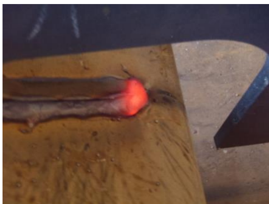
(a) 廻し溶接部先端の赤色状況
