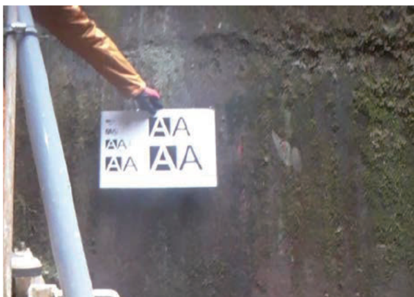
No.1 集水井 GL-4.0m 照度 239.0 lx (右図は標的を拡大)
