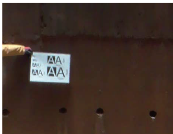
No.1 集水井 GL-11.5m 照度 14.8 lx (右図は標的を拡大)
