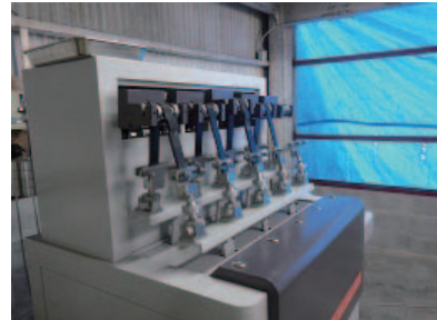
写真 3.2.26 スコット式屈曲試験機
