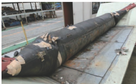
写真 4.1.1 ゴム堰実験機写真
