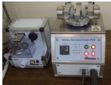
写真 3.2.29 テーバー摩耗試験機
