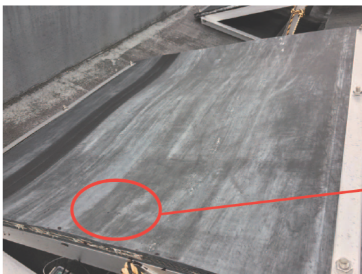
写真 2.2.3 センサーを取り付けたゴム引布供試体
