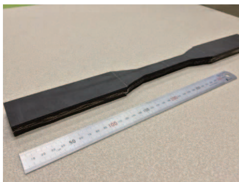
写真 2.2.5 クリープ破断試験片
