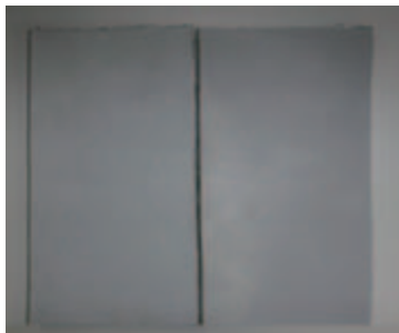
ゴム系塗料 A (左：オリジナル 右：暴露サンプル)
