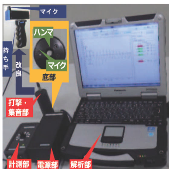
写真 3.1.3 非破壊打音解析装置
