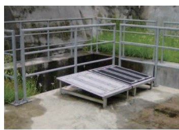
写真 2.1.27 曝露試験片 (空気中)
