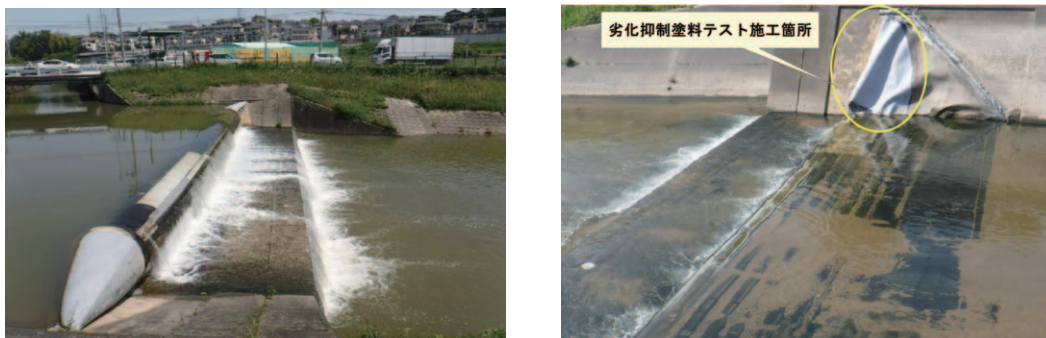
写真 3.2.35 ゴム袋体の老化抑制塗料のフィールド評価状況
