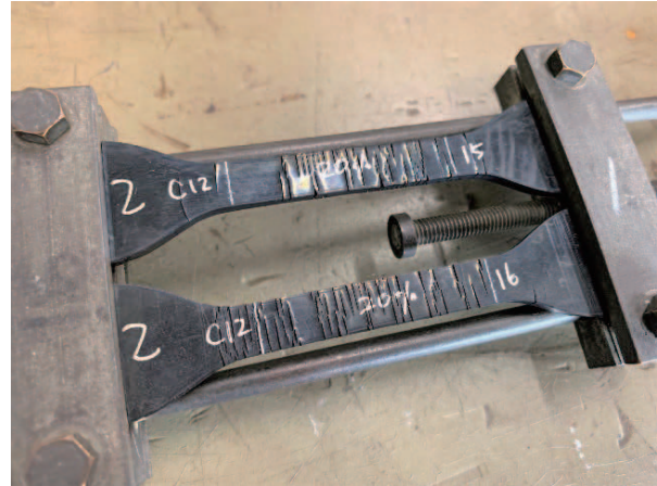
写真 2.2.30 クラック発生状況(② : 20%伸長 48h)
