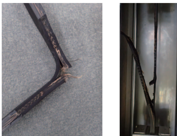
写真 2.2.6 クリープ破断のモード (左:繊維破断型、右:せん断はく離型)
