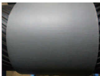
ゴム系塗料 B 写真 3.2.25 試験後 (10,000 回)
