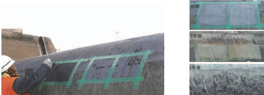
写真 3.2.34 摩耗抑制を目的とした塗料のフィールド評価
