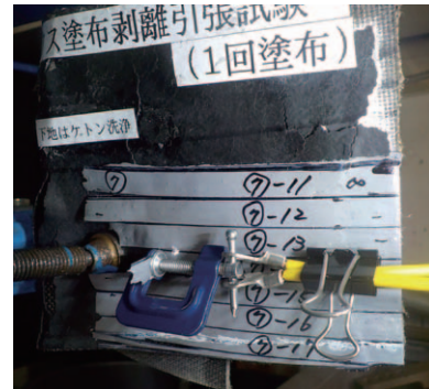
写真 3.2.33 接着力試験状況
