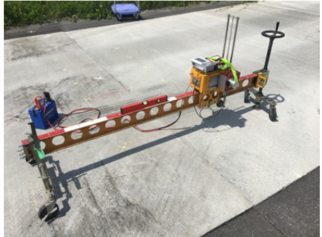
図-3.3.2. 路面プロファイラ
