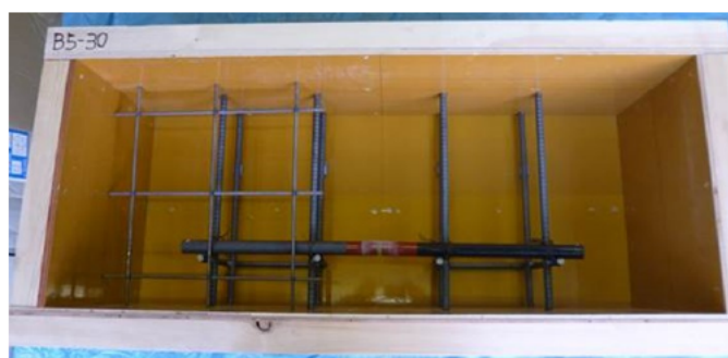
写真-3.2.4 ダウエルバー、チェア、鉄網の配置状況
