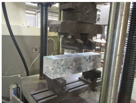
写真-5 曲げ強度試験状況
