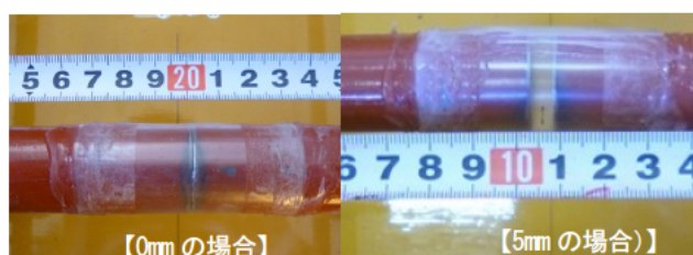
写真-3.2.3 模擬破断部の隙間
