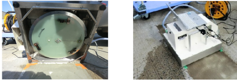
写真-9.5.1 回転式すべり抵抗測定器による動的摩擦係数の測定状況
