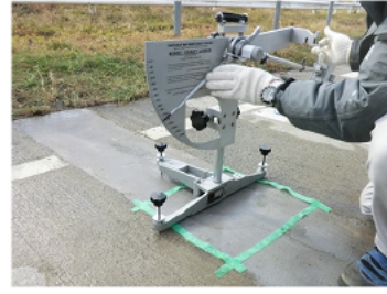
写真-7.2.2 振り子式スキッドレジスタンステスト によるすべり抵抗測定状況
