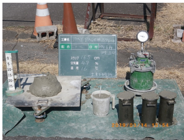
写真-2.6.1 スランプ試験結果
