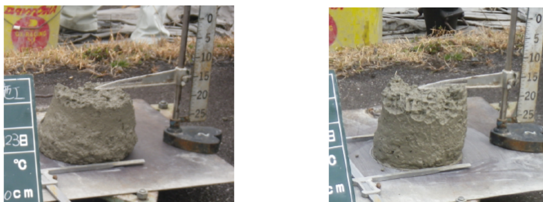
(1) 単位粗骨材かさ容積 0.6\text{ m}^3/\text{m}^3 (配合 1) の場合 (2) 単位粗骨材かさ容積 0.7\text{ m}^3/\text{m}^3 (配合 2) の場合 写真-2.4.1 スランプ試験状況
