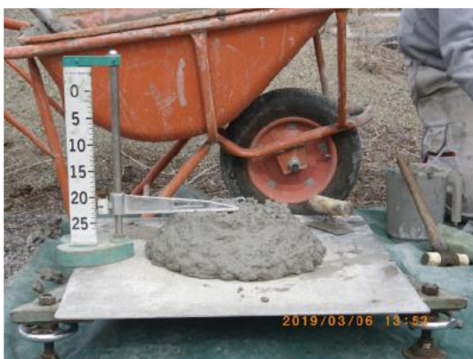
写真-2.5.5 スランプ試験結果
