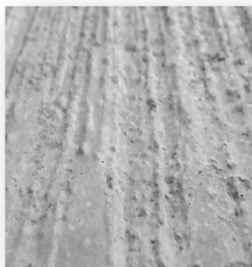
(1) 早めに粗面仕上げを行った例 (テクスチャが適切に形成されていない)
