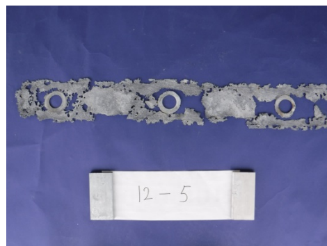
写真-5.5.3.22 陽極表面処理後 12-5
