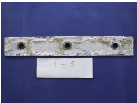
写真-5.5.3.11 陽極撤去後 11-5
