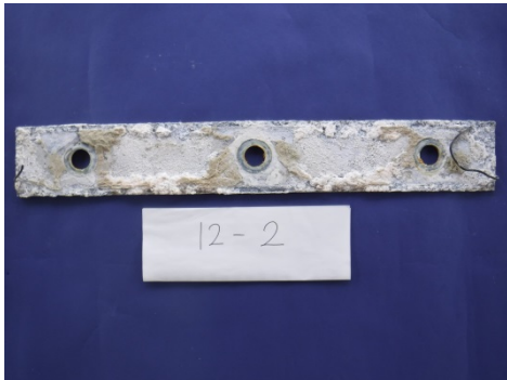
写真-5.5.3.15 陽極撤去後 12-2
