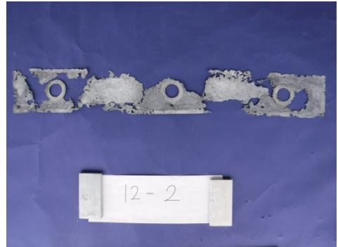
写真-5.5.3.16 陽極表面処理後 12-2
