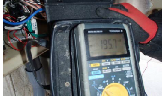
写真-4.6.1 電位値不安定の状況 (17.1mV → 195.7mV)
