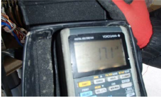
写真-4.6.1 電位値不安定の状況 (17.1mV → 195.7mV)
