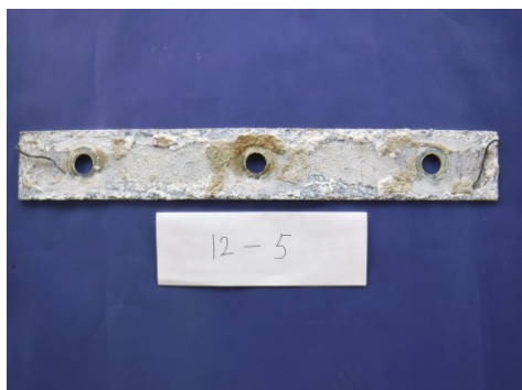
写真-5.5.3.21 陽極撤去後 12-5
