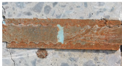
c) No.14 : T1、外径 47.4mm、長さ 168mm
