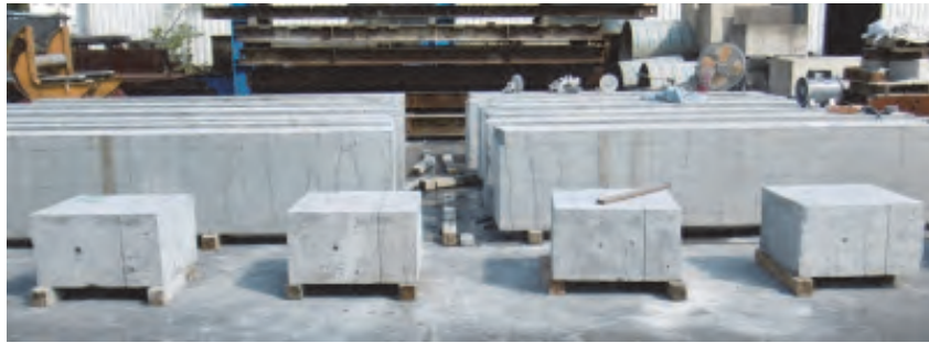
a) 機械式継手部の切り出し後の状況
