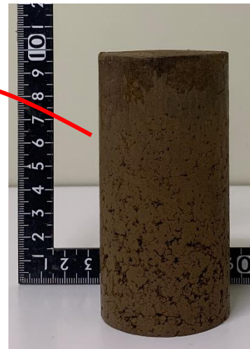
供試体寸法：直径 \phi 50 mm、高さ h 100 mm
