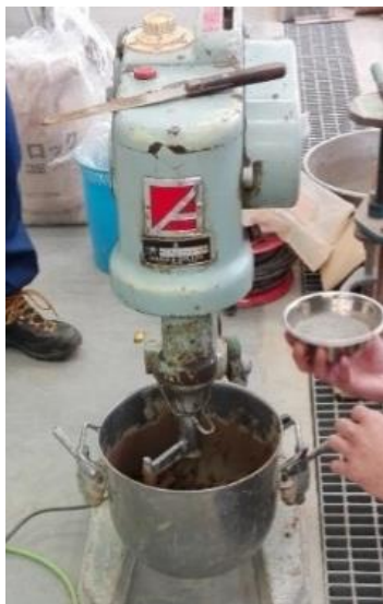
図 2.2-1 ソイルミキサによる試料混合状況
