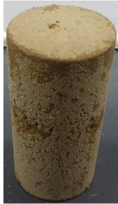
図 2.2-11 供試体表面の白色析出物
