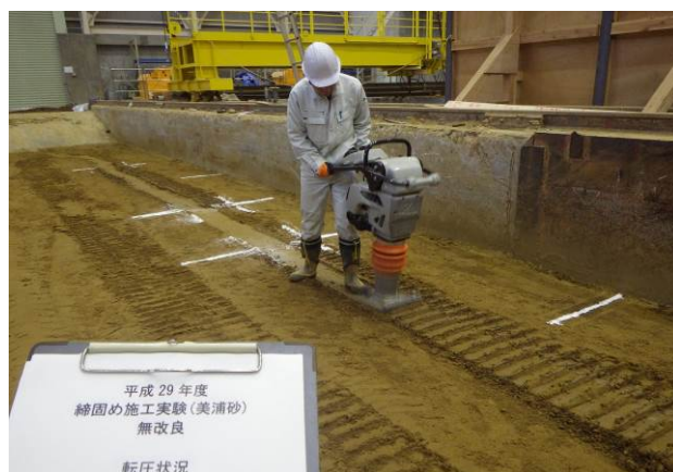
図 7.3-6 締固め機械による締固め状況 (美浦砂及び美浦砂改良土)
