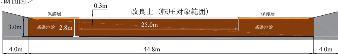
図 7.2-4 締固め実験ヤード
