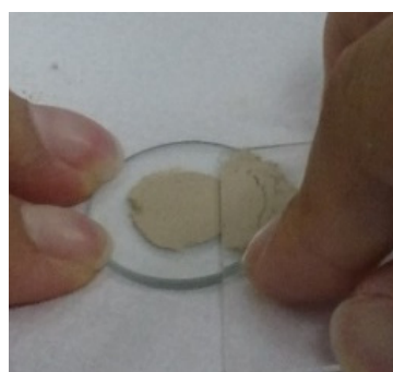
a) 試料充填・均し状況
