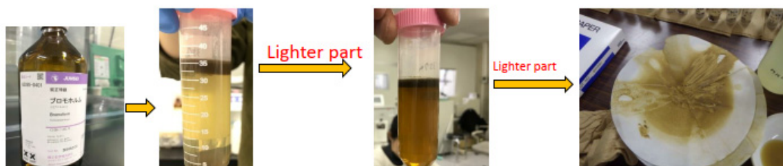
図 4.2-14 ブロモホルムによる重液分離手順 26) より引用
