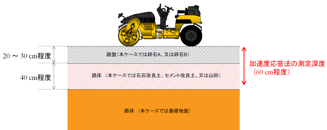
付図 F-20 加速度応答に反映される地盤剛性の範囲（路盤とその下の改良路床を含む）
