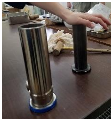
図 2.2-2 静的締固めによる供試体作製状況
