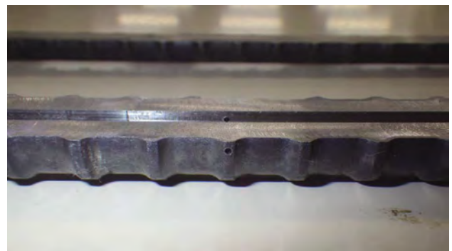
図-2.2.4 半割鉄筋の配線用孔
