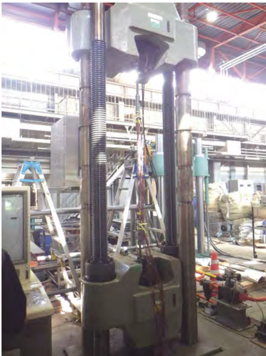
図-2.2.9 弾性範囲内での半割鉄筋の引張試験
