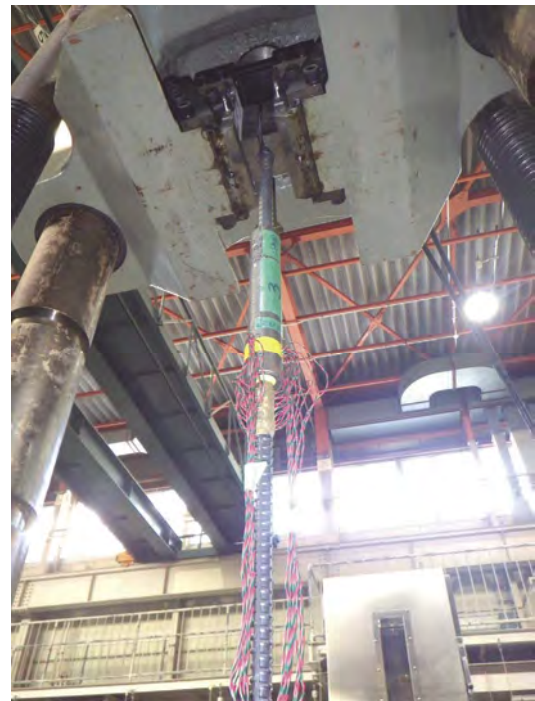
図-2.2.9 弾性範囲内での半割鉄筋の引張試験
