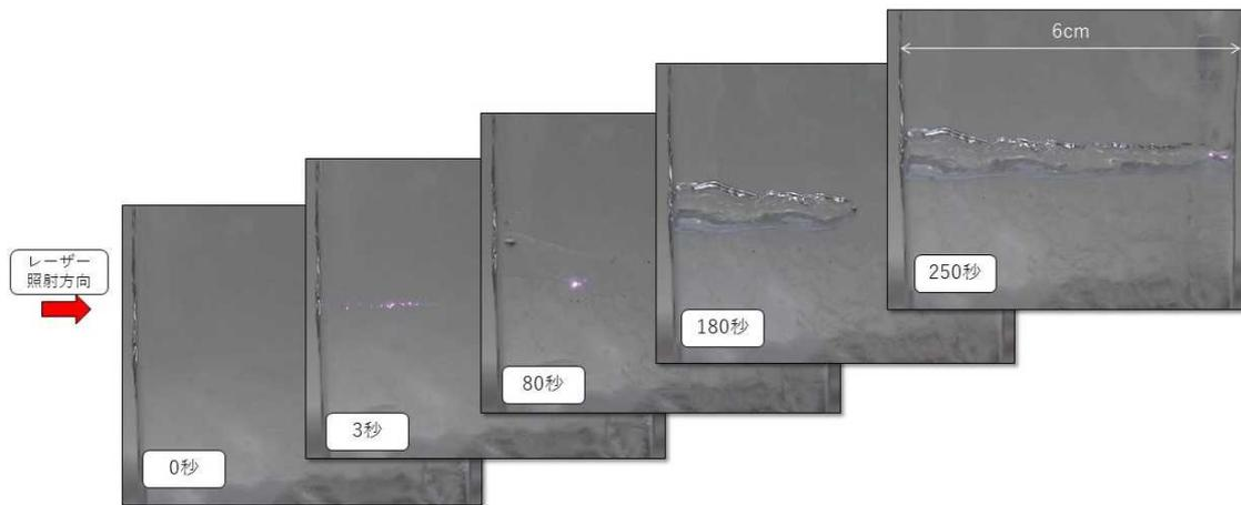
図4 半導体レーザー（波長0.976 $\mu\text{m}$ ）による氷の融解（6.88Wのとき）
