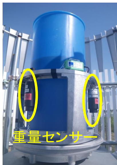
図-7 重量式雨量計の内部
