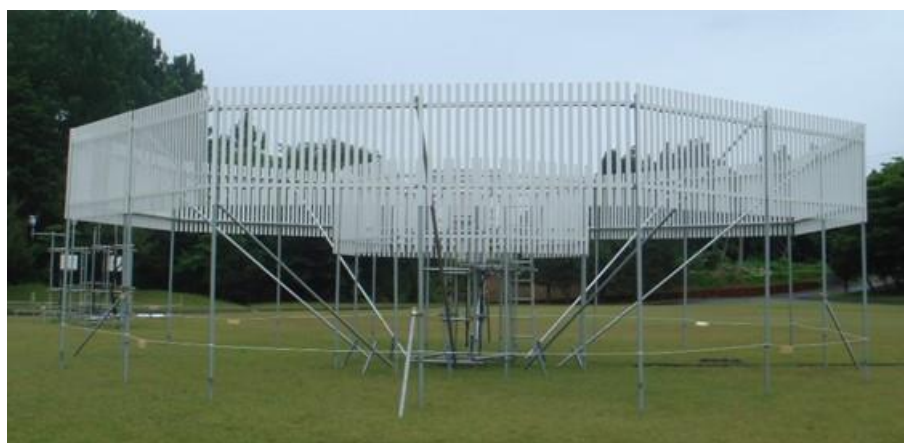
図6 雪氷防災研究センター構内に設置された DFIR 雨量計
