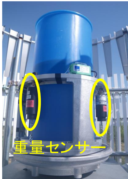
図9 重量式雨量計の内部
