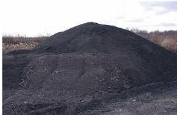
写真-1 アスファルト廃材の置き土状態（静置から2か月後）
