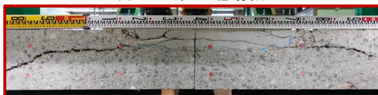
写真 2-4 輪荷重走行試験終了後の切断面 (走行軸直角方向)
