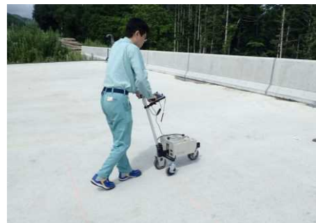
写真-1 表面形状の測定状況
