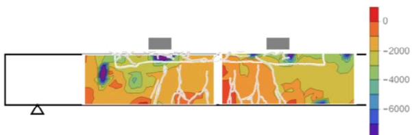
図-7 RD/50 最小主ひずみ分布図 (52.9kN,5.78mm)
