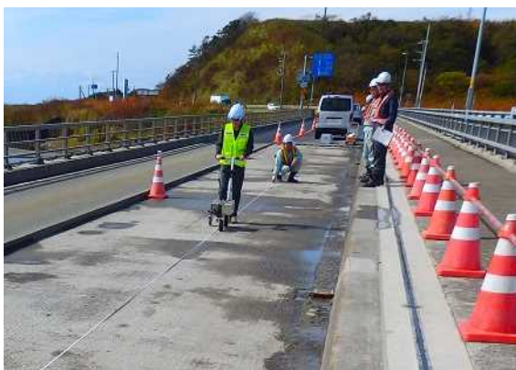
写真 2-2 牽引式路面性状測定装置による床版面形状の測定状況
