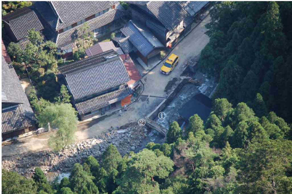
図 4.6.2 屋堂羅川の被害状況（閉塞・堆積の発生した橋梁部） 2)
