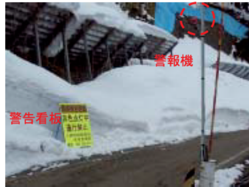
写真 5-33 ワイヤセンサーおよび傾斜センサーによる雪崩警報システム 6)
