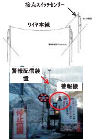
図 5-16 ワイヤセンサーを用いた雪崩発生感知・通報システム
