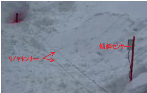
写真 5-33 ワイヤセンサーおよび傾斜センサーによる雪崩警報システム 6)
