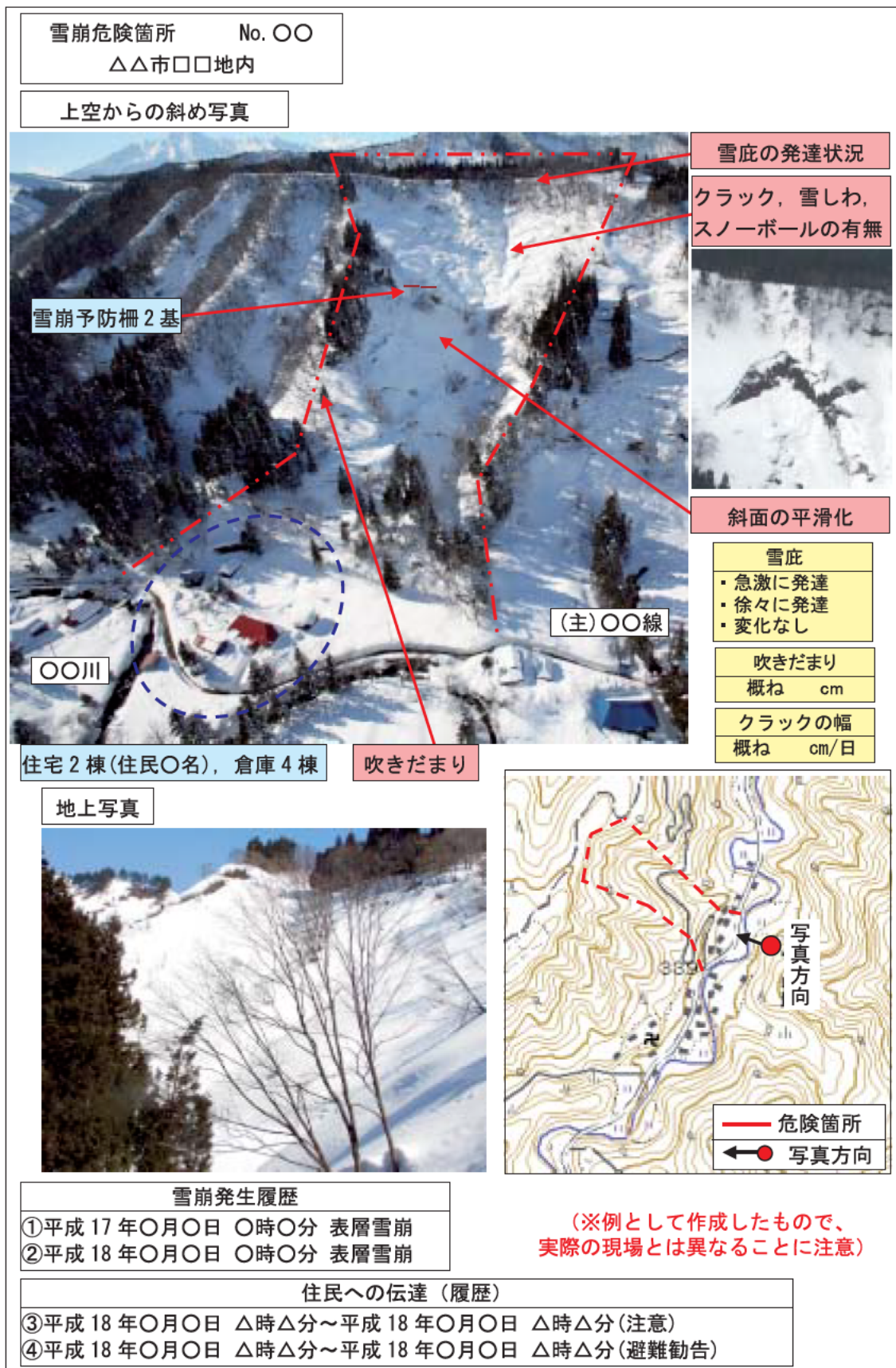
図 3-28 雪崩危険箇所点検カルテの作成例
