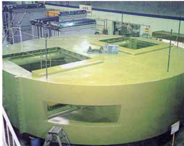
写真-2.3 工場仮組状況全景
