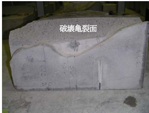
写真-6.2 実験後の破壊亀裂面 (実験No.K-2)
