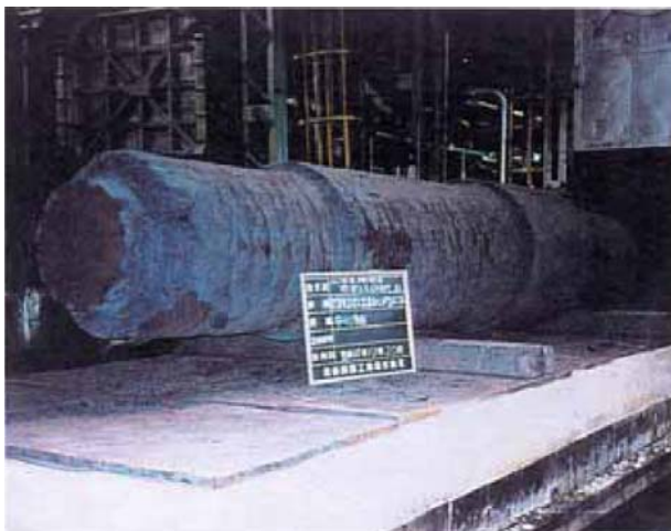
写真-2.1 火造り後の芯出し状況 (火造り：鋼塊をプレス機にて鍛錬する事)
