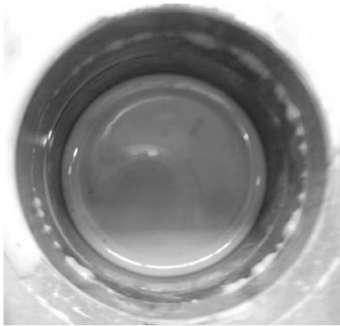
図-15 試験終了後のスリット内側のフィルターケーキ（注入圧力 0.1MPa, 上：超微粒子セメント, 下：球形化した超微粒子セメント）
