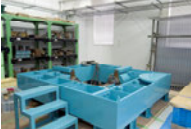
写真 室内せん断試験装置
