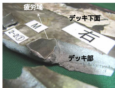
写真 - 2 観察孔 M の破面観察
