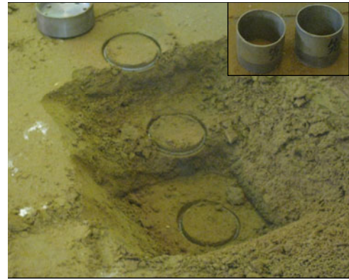
写真2 コアサンプリング状況
