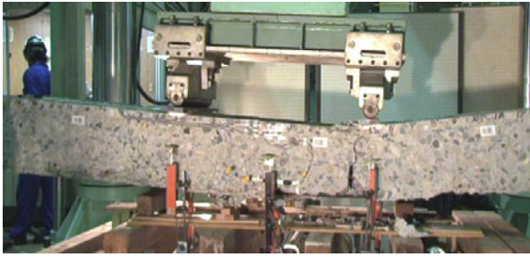
写真-5 載荷試験終了後の状況
