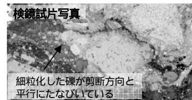
図-4 試料2のすべり面付近のコア断面
