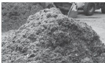
図 2.1.2-2 A 細破碎機で破碎した刈草
