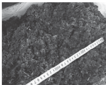
図 2.1.2-6 C 万能破碎機で破碎した刈草
