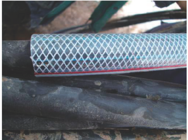
写真3-6 ホースのみで接続した例 (メッシュ構造により引っ張ると径が縮まり抜けない)
