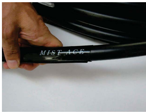
写真3-16 平形ホースを丸形ホースに被せたところ
