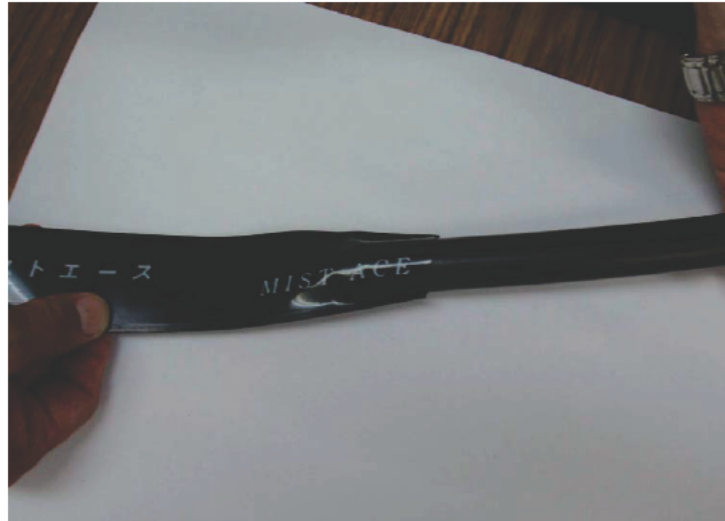
写真3-17 丸形ホースと平形ホースをテープでしばったところ
