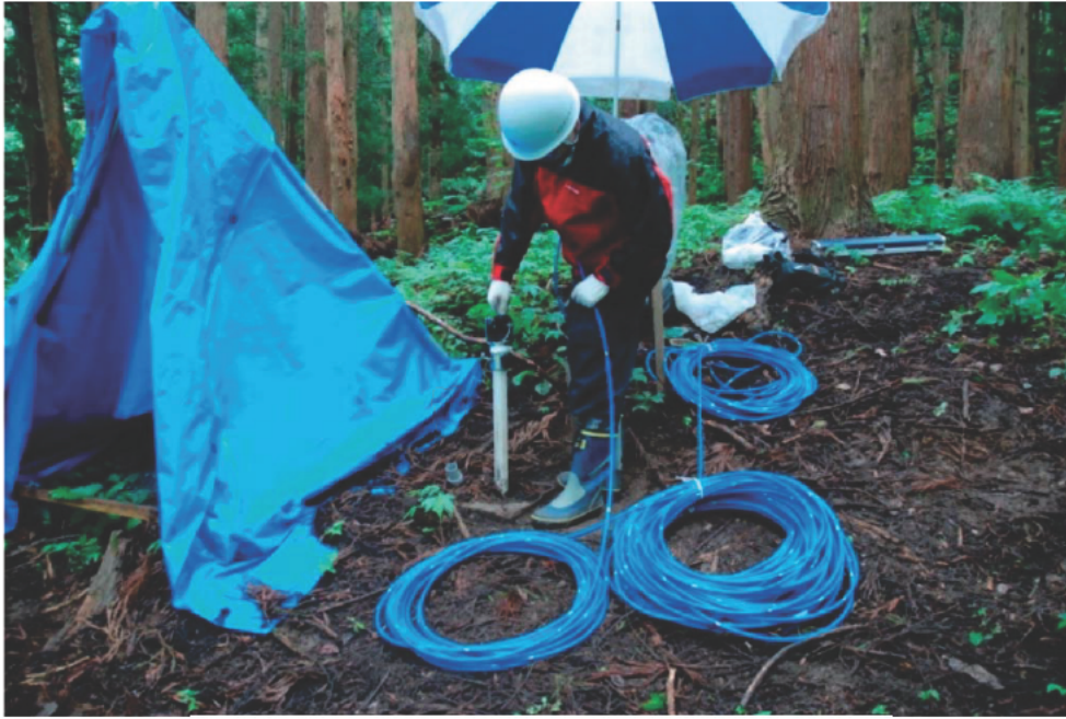
写真4-5 計測時のケーブル巻きとり
