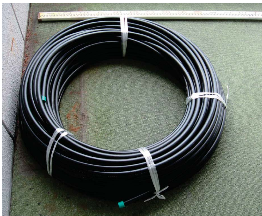
写真 3-4 一般的な丸形グラウトホースの例
