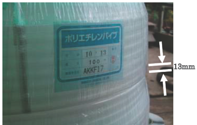
写真3-1 細いグラウトホースの例(内径10mm 外径13mm)
