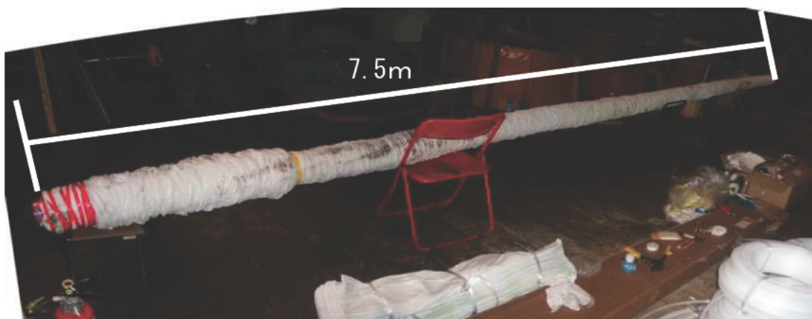
写真3-23 長尺のパッカーを被せた塩ビ管の例
