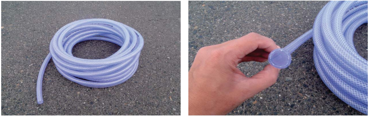
写真 3-38 2回目の設置時に使用した耐圧ホース（外径 13mm）
