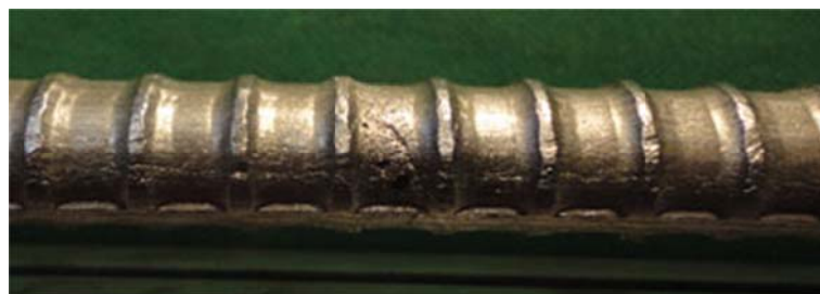
(b)比較的軽微な断面欠損を伴う腐食
