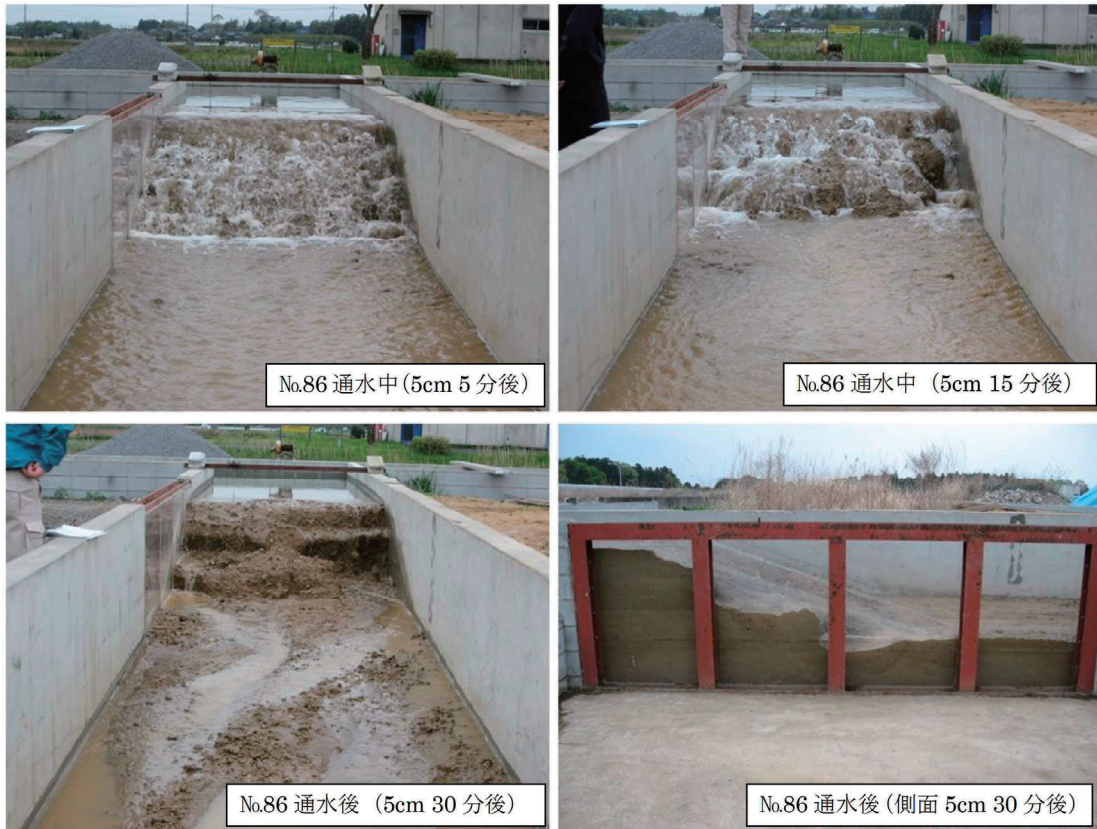
写真-2.25 小型模型実験の状況（ケース86、堤体・基盤：高締固め度）
