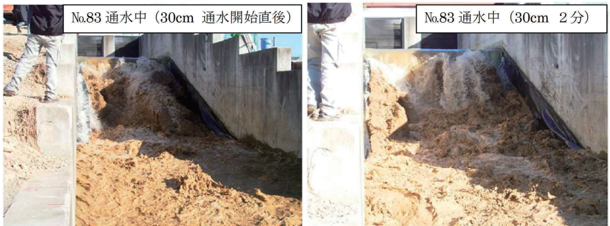
写真-2.4 湛水有り、吸出し防止シート有りの実験 (ケース82)
