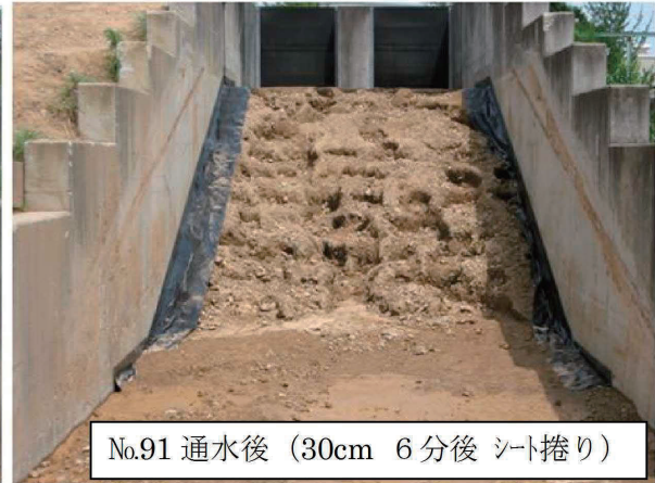
写真-2.14 対策工の実験状況 (ケース91、堤体材料 d_m \approx 2.0\text{mm} )
