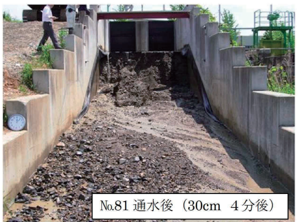
写真-2.13 裸堤の実験状況 (ケース81、堤体材料 d_m \doteq 10.0\text{mm} )
