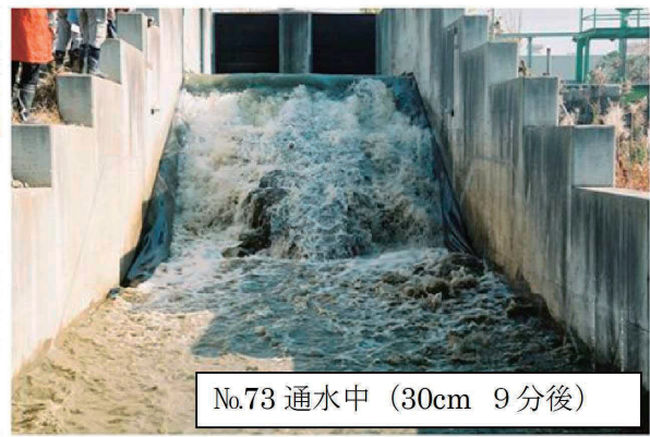
写真-2.11 裸堤の実験状況 (ケース73、堤体材料 d_m \doteq 10.0\text{mm} )
