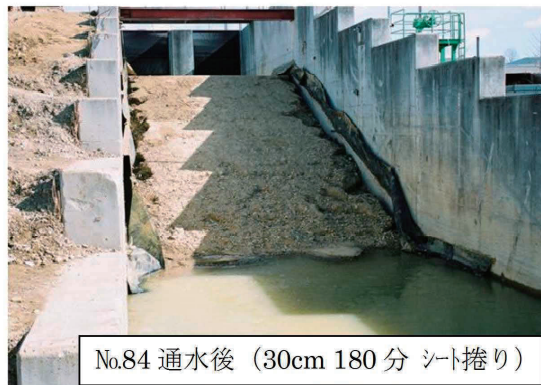
写真-2.6 湛水無し、吸出し防止シート有りの実験 (ケース84)
