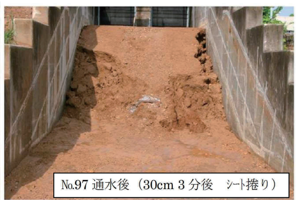
写真-2.21 遮水シートの重ね代30cmの通水実験状況 (ケース97)
