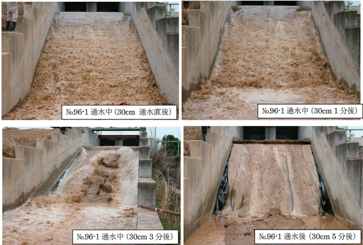
写真-2.18 吸出し防止シートの重ね代30cmの1回目の通水実験状況 (ケース96-1)
