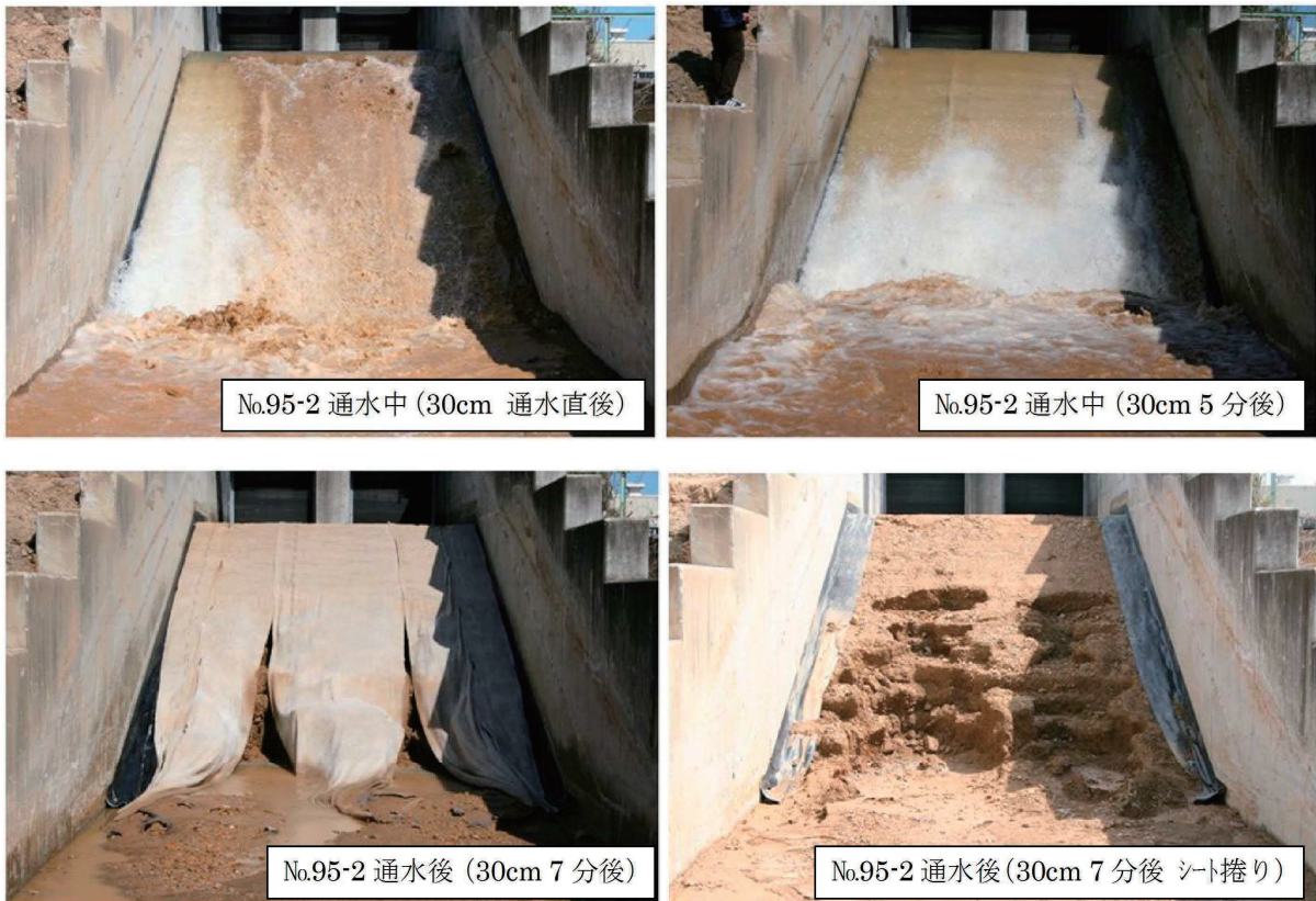
写真-2.17 吸出し防止シートの重ね代15cmの2回目の通水実験状況 (ケース95-2)
