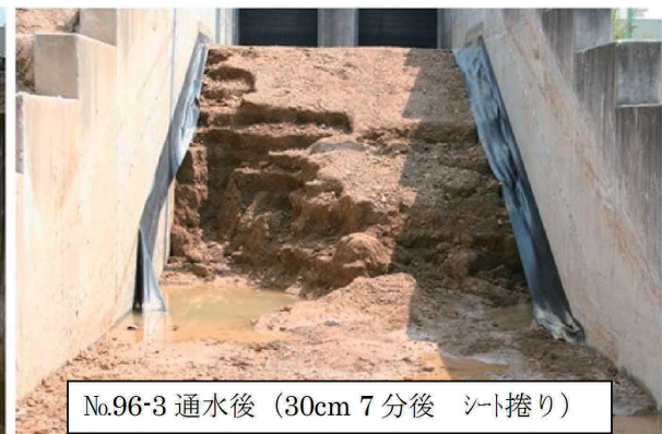
写真-2.20 吸出し防止シートの重ね代30cmの3回目の通水実験状況 (ケース96-3)
