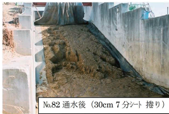
写真-2.4 湛水有り、吸出し防止シート有りの実験 (ケース82)
