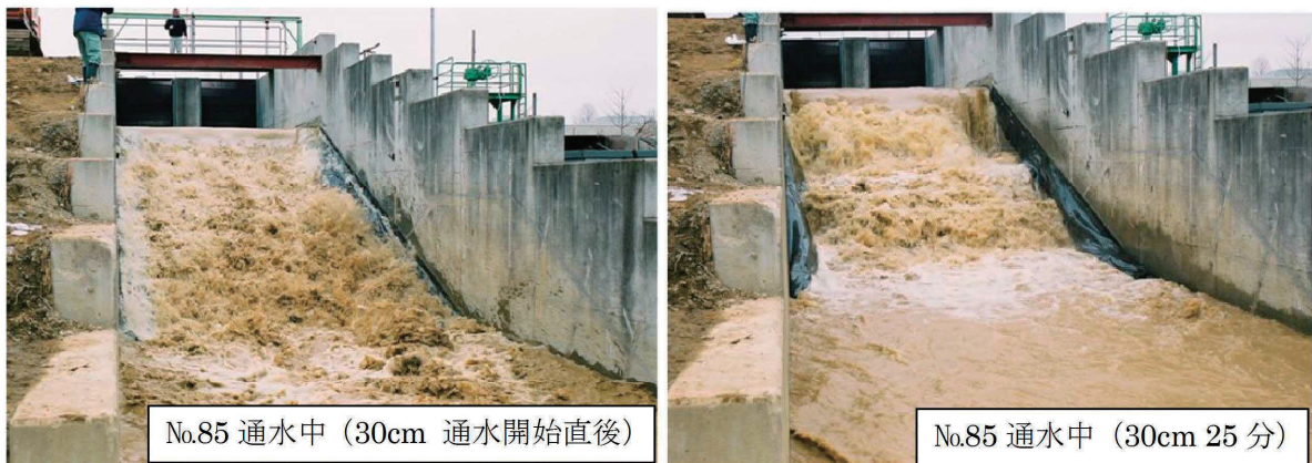
写真-2.6 湛水無し、吸出し防止シート有りの実験 (ケース84)
