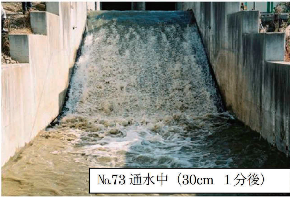
写真-2.11 裸堤の実験状況 (ケース73、堤体材料 d_m \doteq 10.0\text{mm} )
