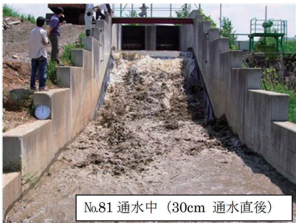
写真-2.13 裸堤の実験状況 (ケース81、堤体材料 d_m \doteq 10.0\text{mm} )
