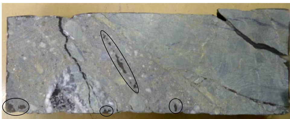
写真 4.3 粗研磨中の標本断面（線で囲った位置に凹が残っている）
