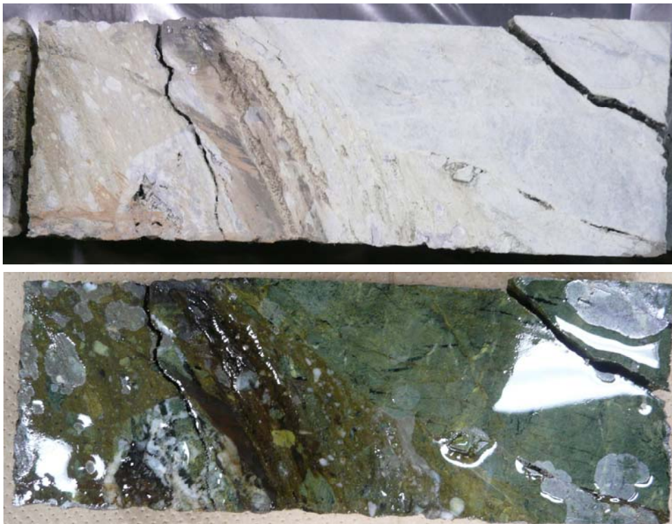
写真 4.1 切り出した直後の標本断面（上）と樹脂を浸透中の標本断面（下）
