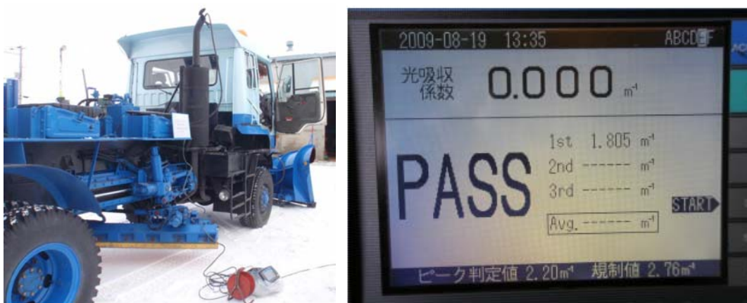
写真-7 粒子状物質 (PM) 測定試験
