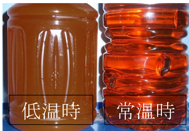
写真－9 始動不能時の燃料フィルタ及び燃料の状態
