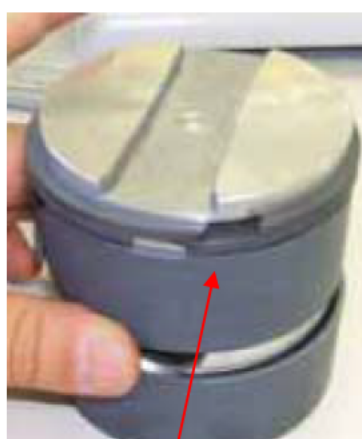
写真-20 ピストンリング取付状況
