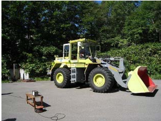
写真－5 牽引力試験状況
