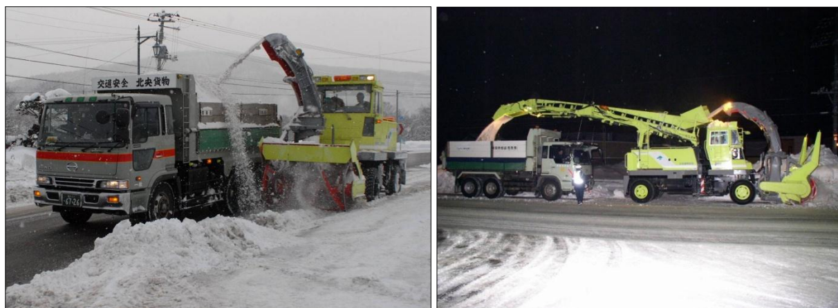
写真-4 運搬除雪作業状況(左:並列積み込み、右:縦列積み込み)
