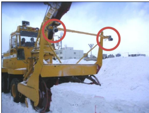
写真- 11 レーザースキャナ取付状況
