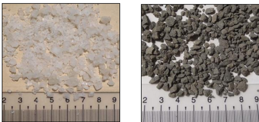
写真- 2 左側：凍結防止剤（塩化ナトリウム） ・ 右側：防滑材（7号砕石）
