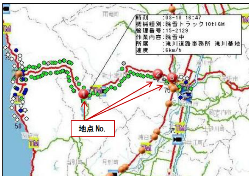
図- 13 除雪作業状況確認システム操作画面（2）
