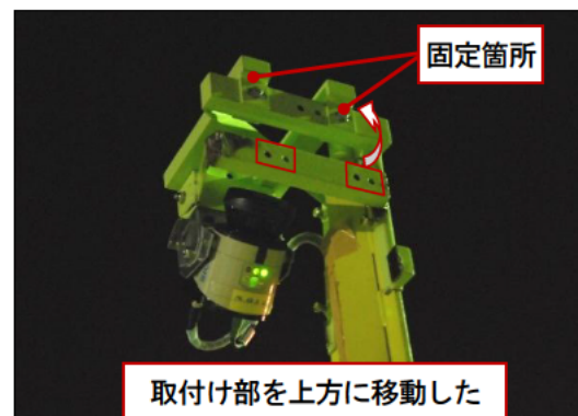
写真- 17 レーザースキャナ固定箇所（左：修正前、右：修正後）
