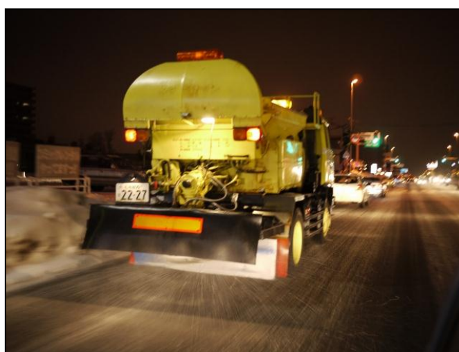
写真- 3 凍結防止剤散布車による散布作業
