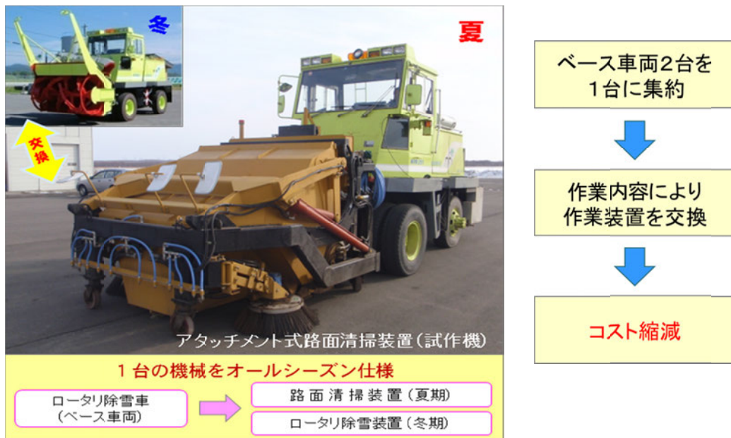
写真-1 ロータリ除雪車に対応した路面清掃装置(試作機)
