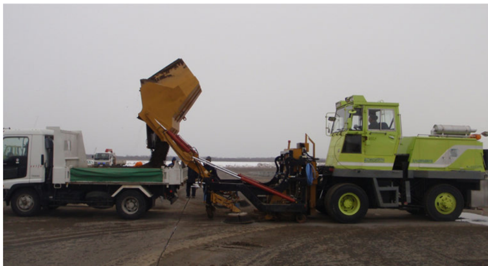
写真-3 ダンプトラックへの積込み試験
