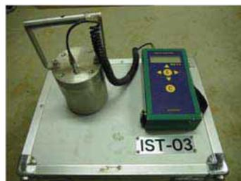
写真-2 超小型動的平板載荷試験装置
