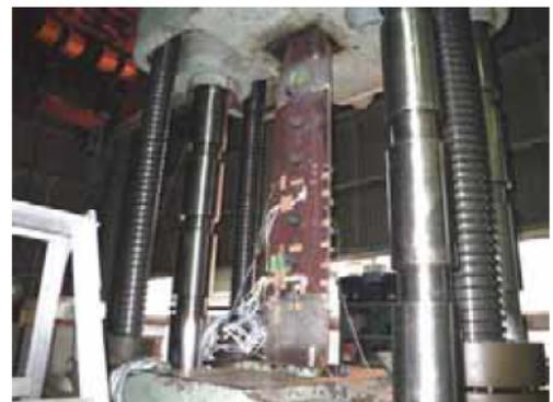
写真-1 供試体の設置状況(静的引張試験)
