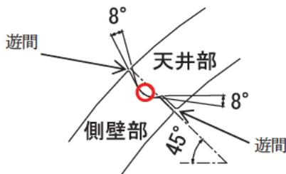
図-6 ヒンジ接合の構造図
