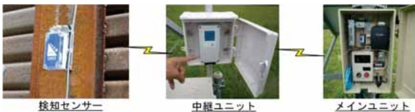
図2.開発した加速度型崩落検知システム
