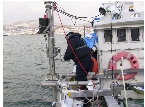
手動巻上機によるカメラ位置変更
