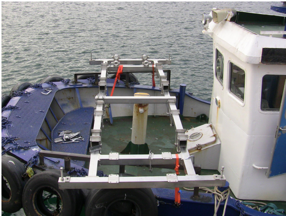
艀装用架台設置
