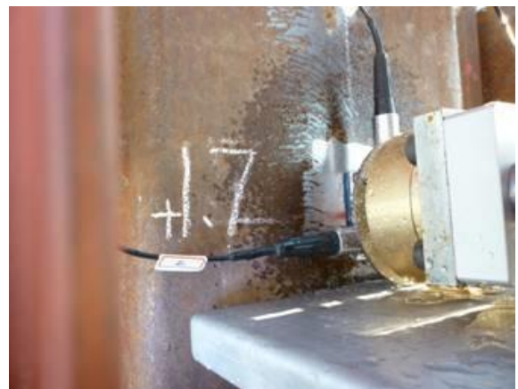
第1回試験 鋼矢板への接触状況
