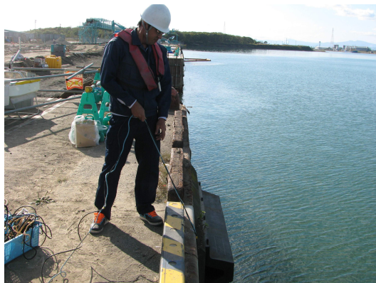
音速度測定状況（岸壁上）
