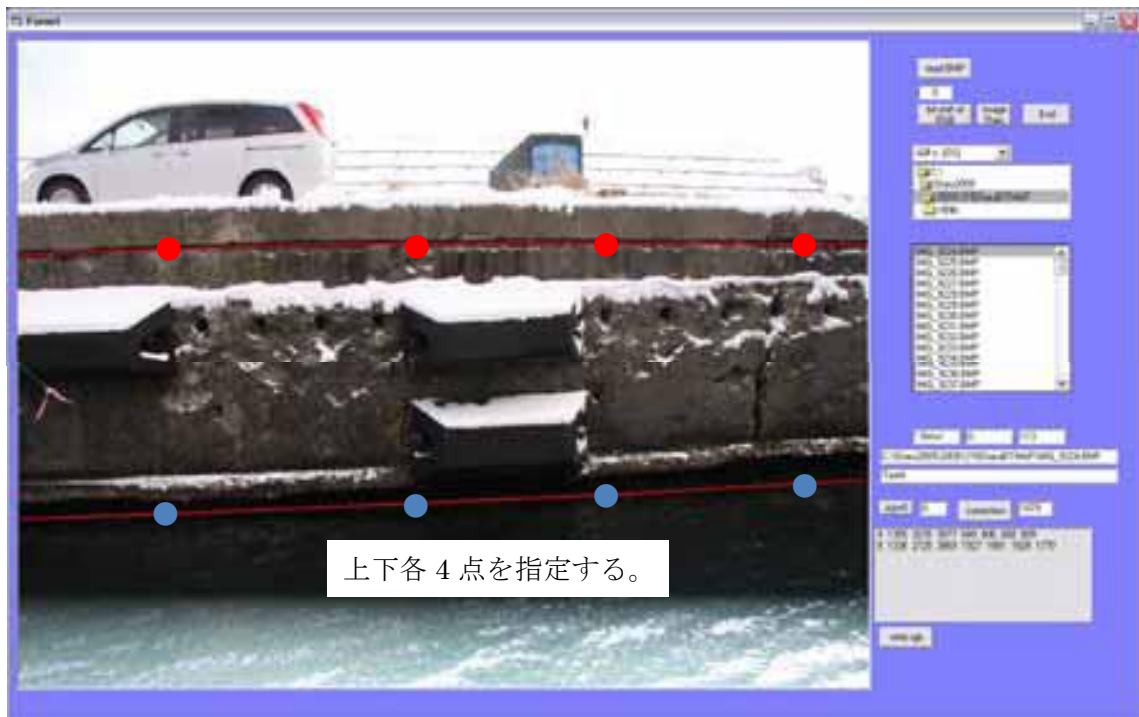
図-10 歪補正ソフトウェア（Project3.exe）の設定画面（歪補正前）
