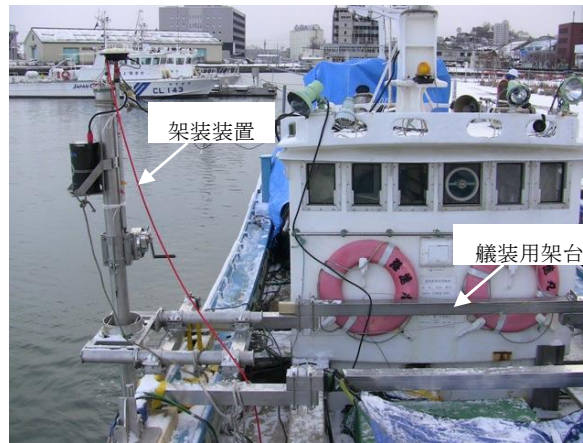
写真-4 架装装置及び艀装用架台
