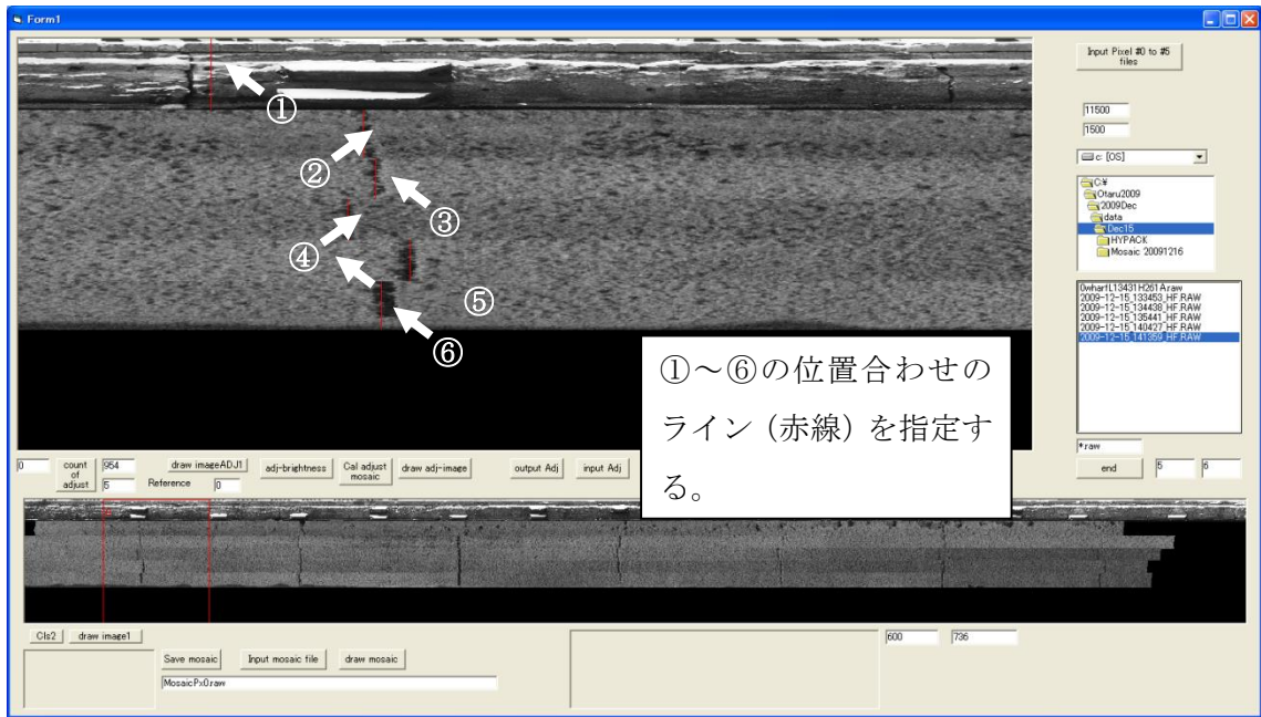
図-9 モザイク図作成（水深方向）ソフトウェア（AdjustMosaic.exe）のキャリブレーション画面
