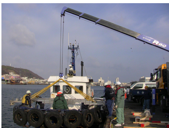
艀装用架台設置
