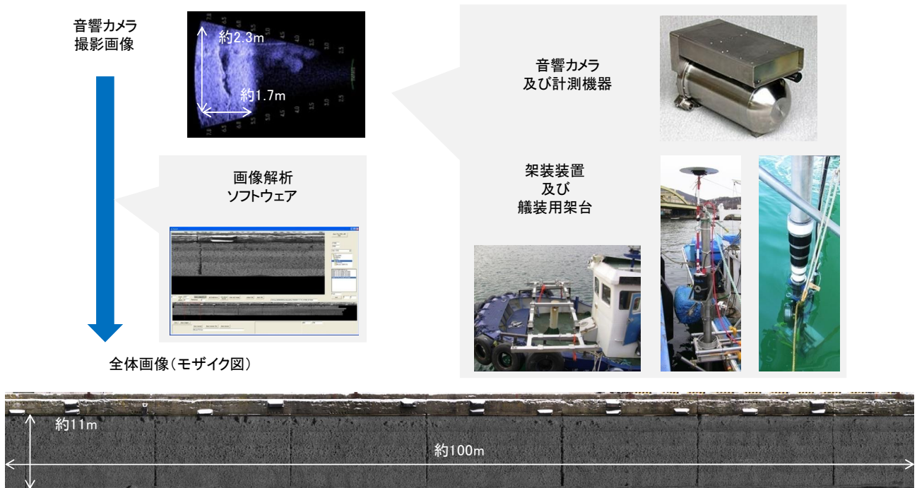
図-2 港湾構造物水中部劣化診断装置 (構成)
