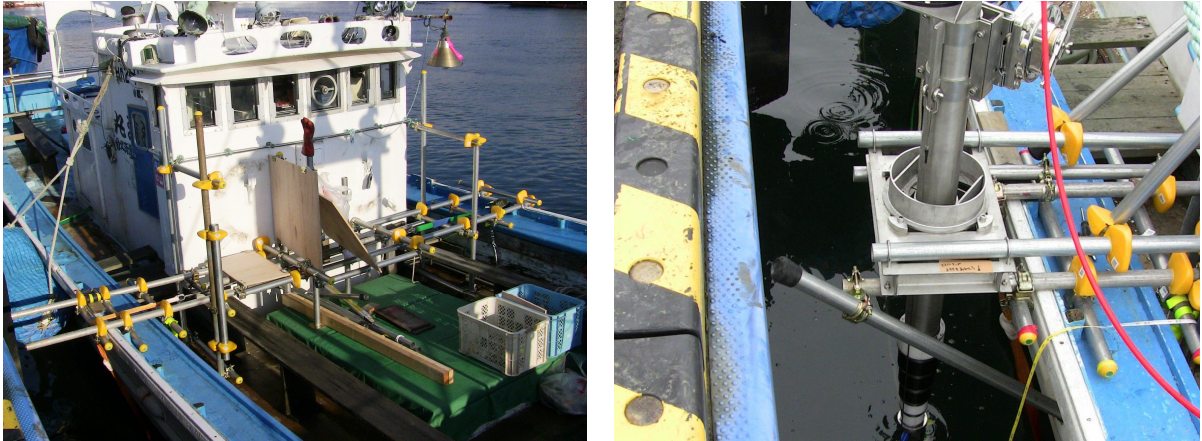
写真-1 単管架台による架装装置の艀装
