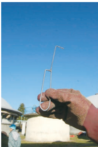
ノズル洗浄棒(写真は小野寺氏より提供)
