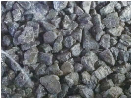
散水ろ床に充填されたろ材(石英安山岩)
