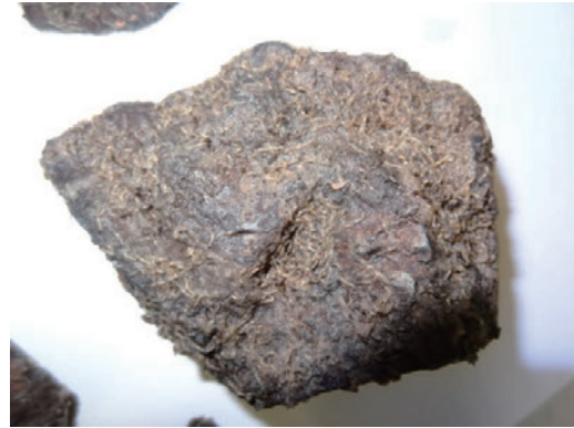
ろ材の表面(糸状の生物が大量に付着している)
