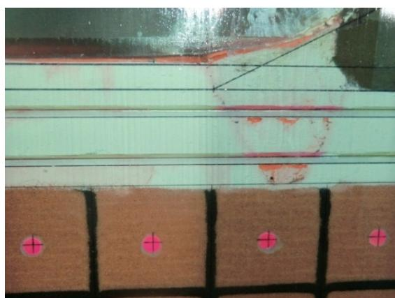
(f) 実験後の模型横断形状（埋戻し部）
