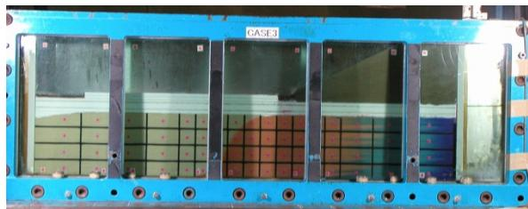
(c) 実験後の模型横断面形状
