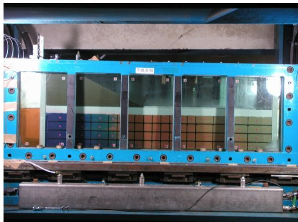
(c) 実験後の模型横断面形状
