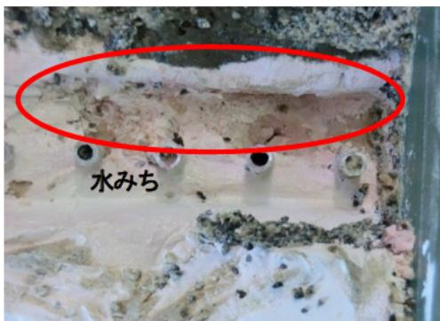
(c) 実験後の平面形状（対策工箇所）
