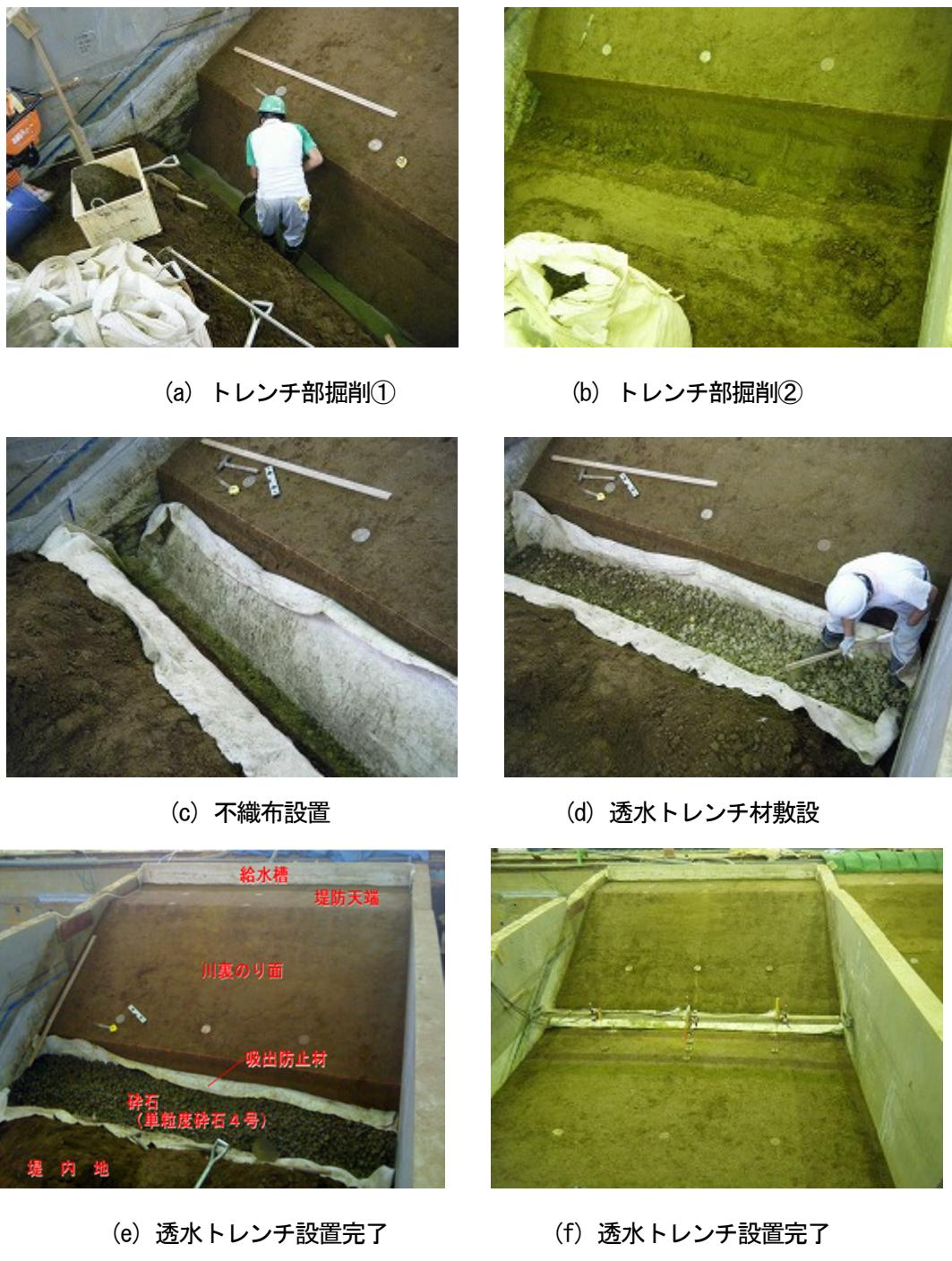
図-0.6 ケース4模型製作状況
