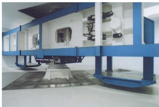
図-2.2.1 大型遠心載荷装置
