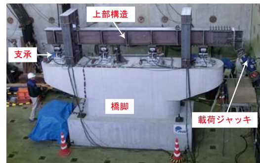
写真-1 供試体全景
