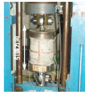
写真-1 直接引張試験状況
