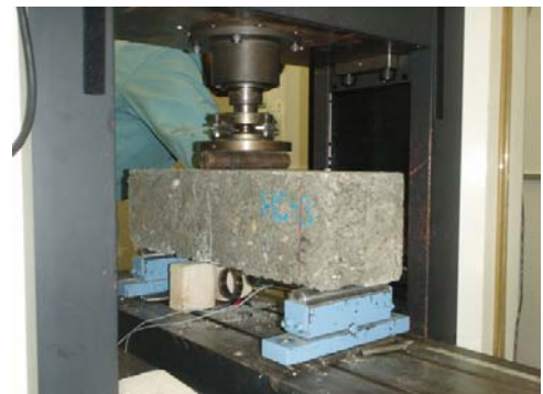
写真-3 破壊エネルギー試験
