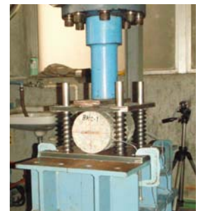
写真-2 割裂引張試験状況
