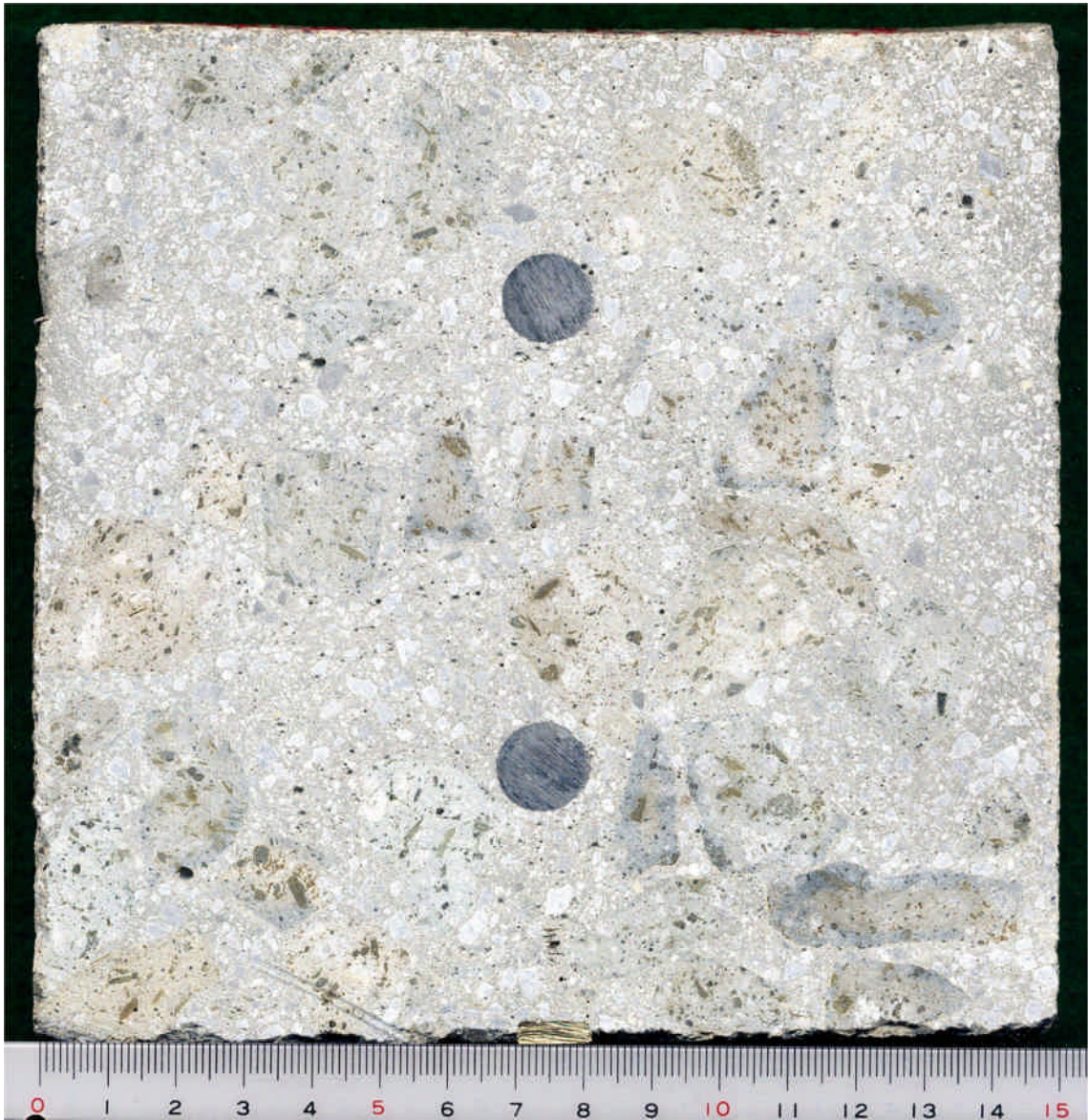
付図-4.9.1 供試体切断面 (82181 3A)
