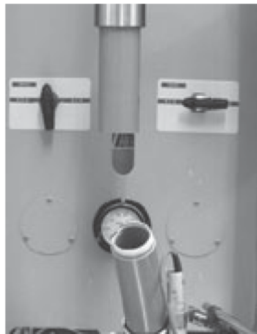
図 解 4-7 引張試験の破断後の状況
