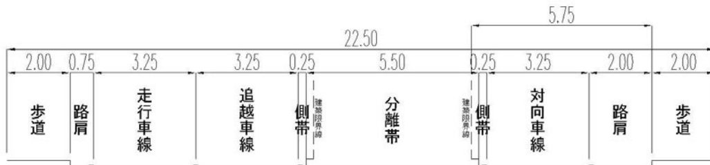
図-3.14 広幅中央帯設置の場合
