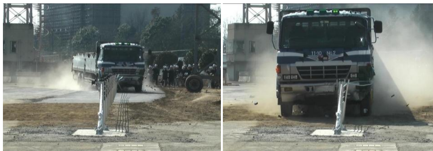
写真-8 防護柵衝突後の大型貨物車の軌跡
