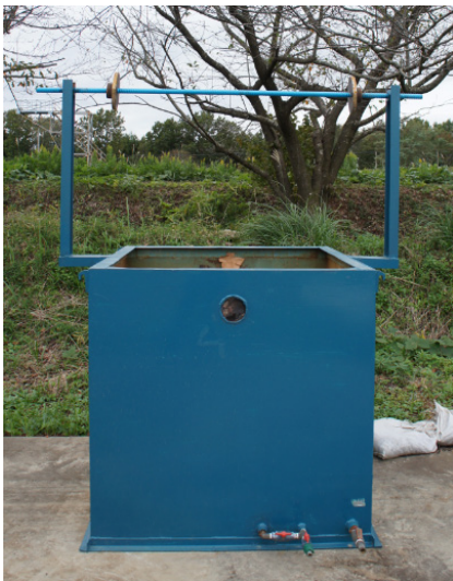
写真-4 固形対象物：鋼製立方体 (1,200mm×1,200mm×高さ1,200mm、 重量約500kg、持ち手高さ2,000mm)
