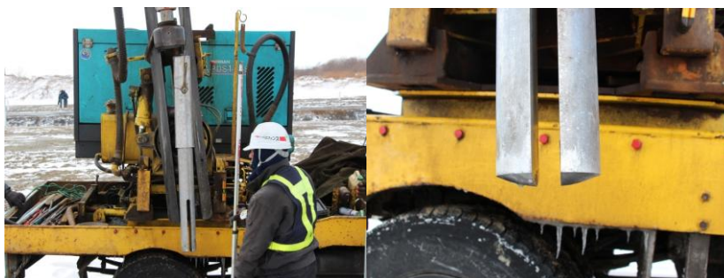
写真-10 打込み治具(左)と先端の形状(右)
