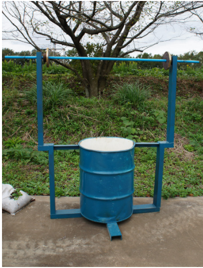
写真-2 固形対象物：ドラム缶 (φ570mm×高さ760mm、重量約100kg、 持ち手高さ2,000mm)
