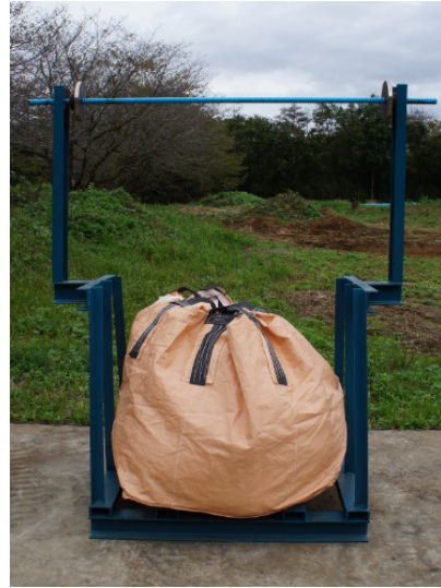
写真-3 固形対象物：土嚢 (800mm×800mm×高さ800mm、 重量約300kg)
