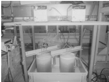
図 2-1 電気分解試験装置
