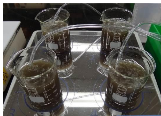
図 4-1 試験の様子 (藻類培養液と活性汚泥を混合し、曝気している)
